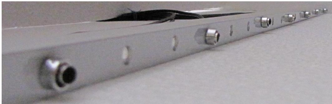
Figura 5.1: Arranjo Uniforme Linear de Microfones
