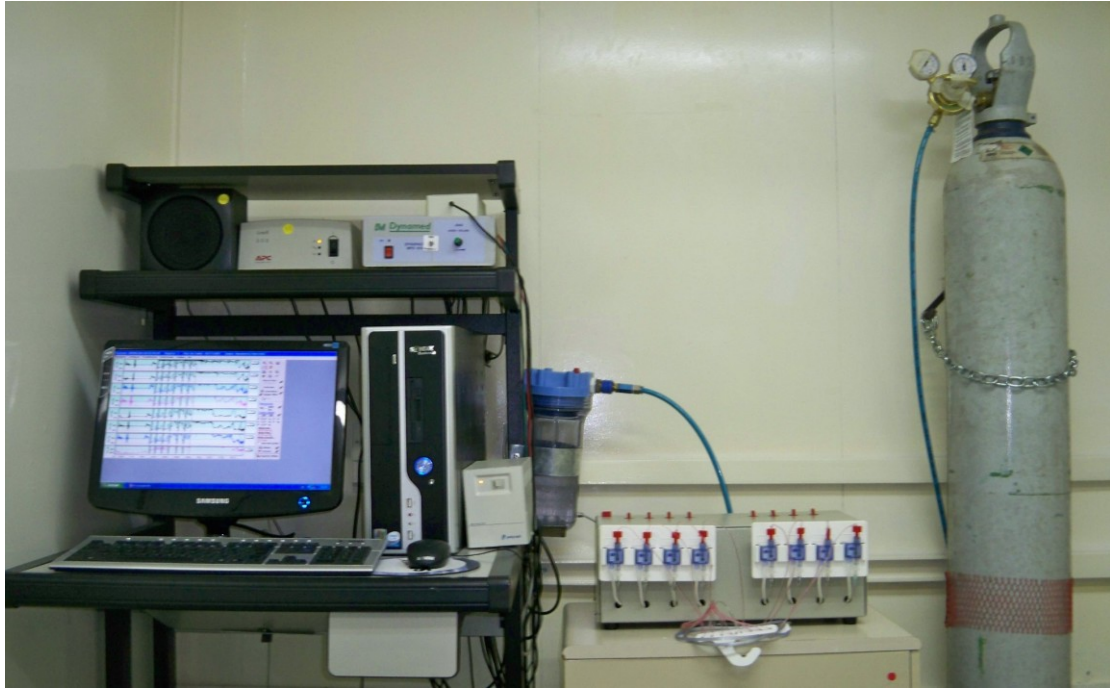
FIGURA 2. Equipamento utilizado para manometria anorretal. Manômetro de oito canais, composto por uma bomba que controla, por meio de pressão fixa de gás nitrogênio, a perfusão de água destilada à velocidade contínua.
