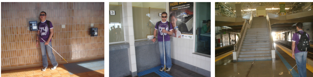
Ilustração 79 – Fotos de orelhão sem sinalização, bilheteria com piso tátil, mas sem atendente, e piso tátil não é direcionado para as escadas fixas, passeio acompanhado com João na Estação de Metrô Terminal Ceilândia.
