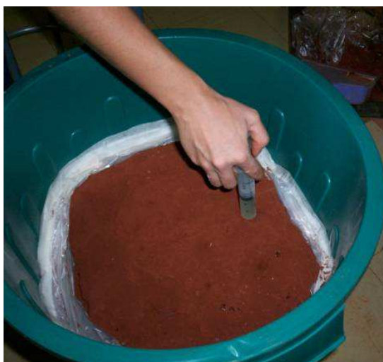
Figura 4.22. Adição do meio B4 nos blocos de solo do perfil da voçoroca de Santa Maria.
