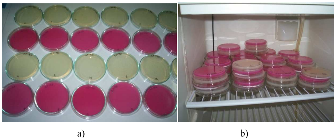
Figura 4.20. a) Placas de petri com o nutriente B4 e com o nutriente com uréia, b) incubação das bactérias.
