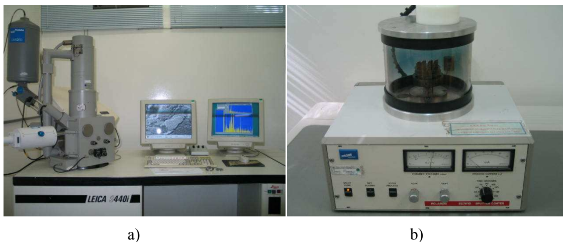
Figura 4.31. a) Microscópio eletrônico de varredura, b) Metalização de amostra para ser analisada no microscópio eletrônico de varredura (Imagem fornecida por FURNAS).
