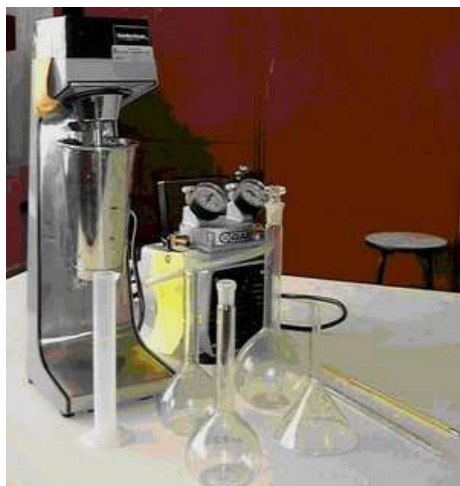
Figura 4.24. Equipamento para determinação do peso específico dos grãos (Imagem obtida de http://ingenieracivil.blogspot.com/2008_07_01_archive.html o dia 07/06/09).
