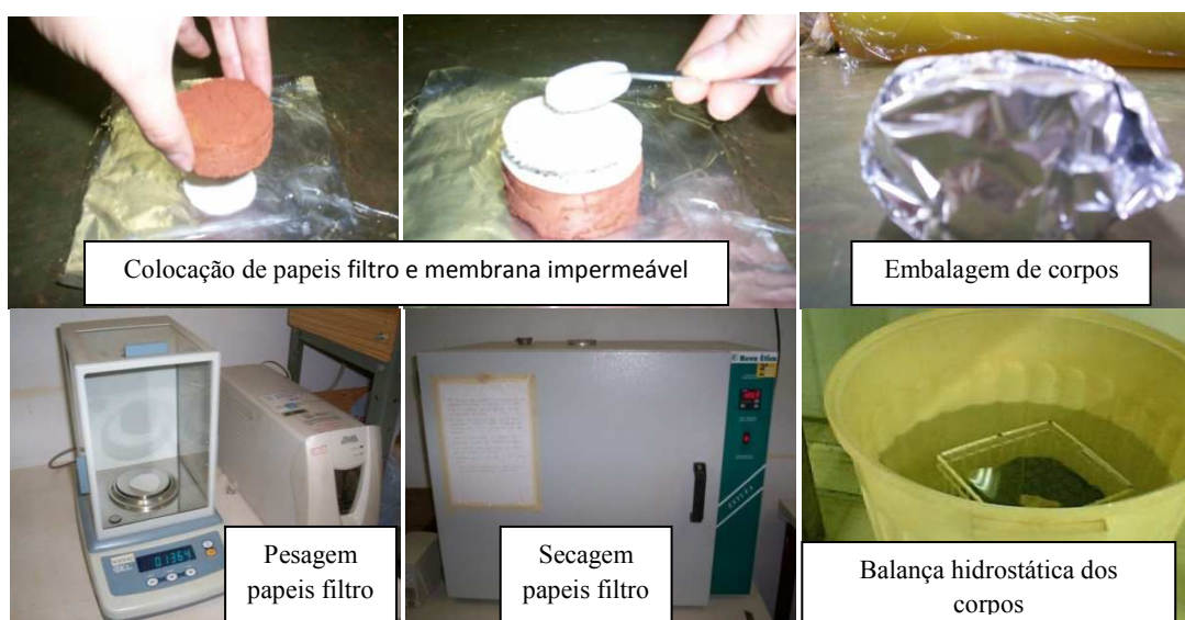
Figura 4.35. Ensaio de sucção total e matricial.
