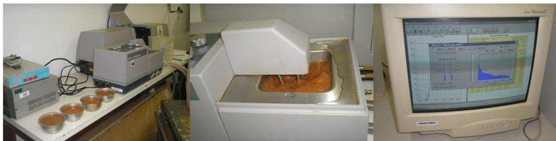
Figura 4.26. Ensaio de granulometria no granulômetro laser da UnB (Imagem obtida de Aulas Geotecnia I-Universidade de Brasília, Camapum de Carvalho, 2005).
