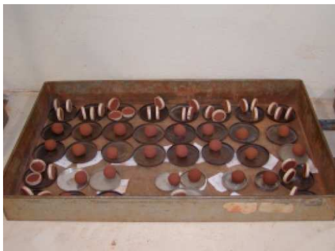
Figura 4.28. Secagem ao ar de pastilhas e bolinhas de solo para o ensaio MCT expedita (Imagem obtida de Lima, 2003).
