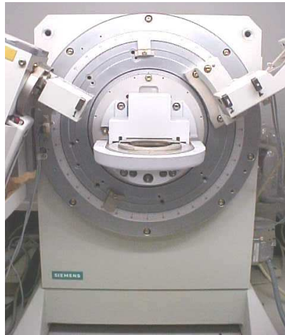
Figura 4.30. Difratorômetro de raios X do Laboratório de Difração de Raios X do Laboratório de Mecânica das Rochas da Divisão de Geotecnia de FURNAS.
