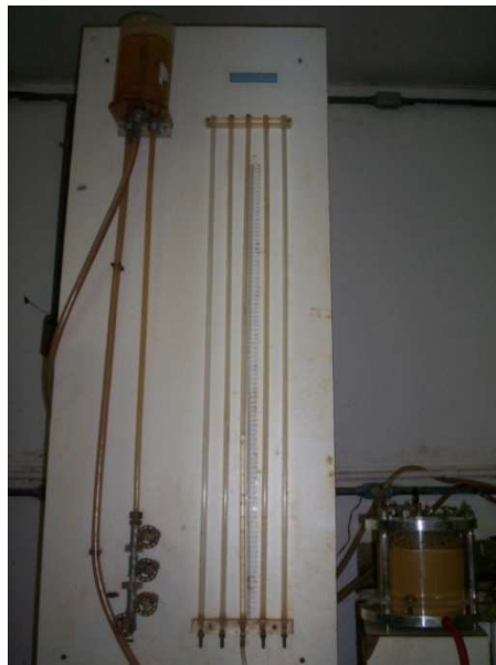
Figura 4.40. Montagem ensaio de permeabilidade.
