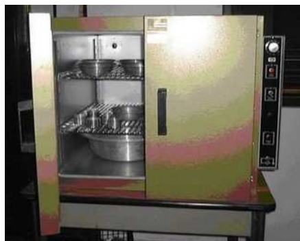
Figura 4.23. Amostra de solo secada na estufa para determinação do teor de umidade (Imagem obtida de http://ingenieracivil.blogspot.com/2008/08/exploracion-muestreo-en-el-campo-y_19.html o dia 07/06/09).
