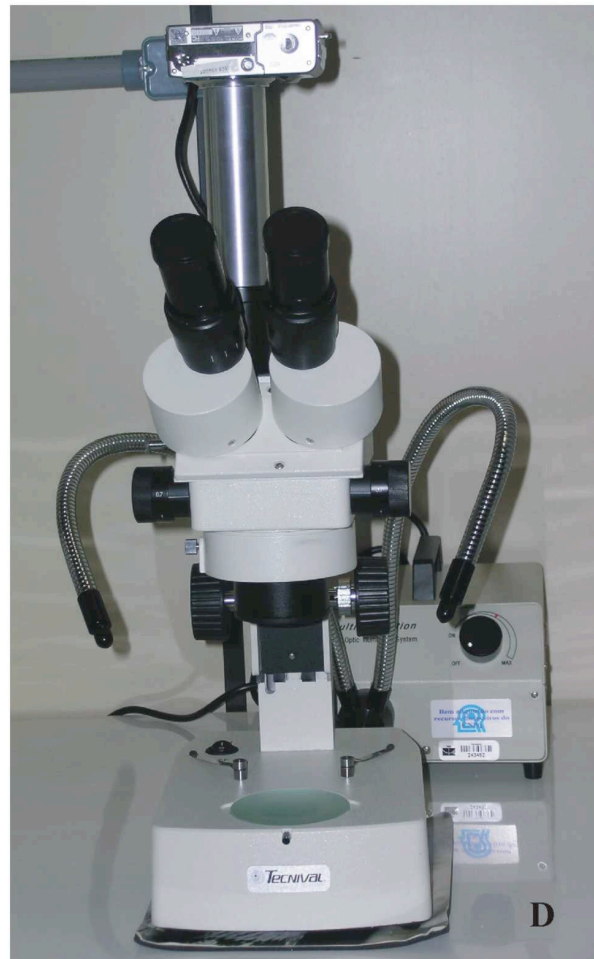
Figura 9. Materiais e equipamentos: A, gaiola de acrílico; B, material de disseção; C, microscópio óptico com câmera acoplada e D, microscópio estereoscópico com câmera acoplada.
