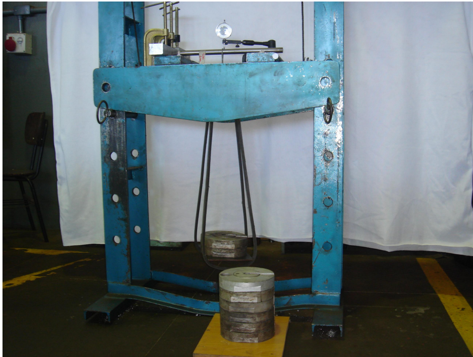
Figura 5.8: Montagem usada na avaliação estática da rigidez do eixo.
