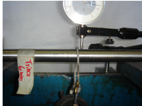
(b) detalhe do entalhe simulando a trinca
