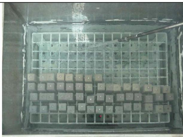
Figura 4.4 – Foto da vista Interna do tanque onde ficam estocadas as barras de argamassa.
