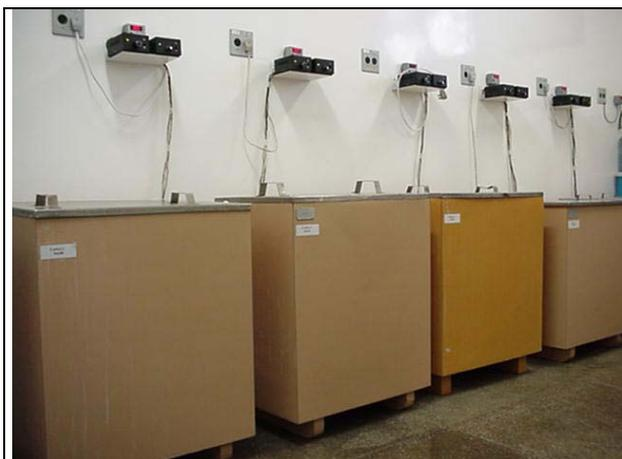
Figura 4.3 – Foto do conjunto de tanques onde ficam estocadas as barras de argamassa.
