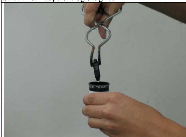
Figura 4.17 – Foto do momento da retirada da amostra do recipiente para a medição/leitura.
