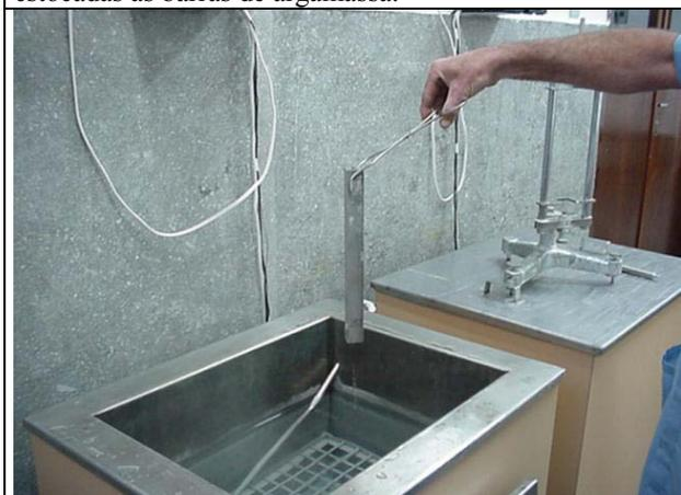
Figura 4.5 – Foto do momento da retirada da barra de argamassa para ser medida.
