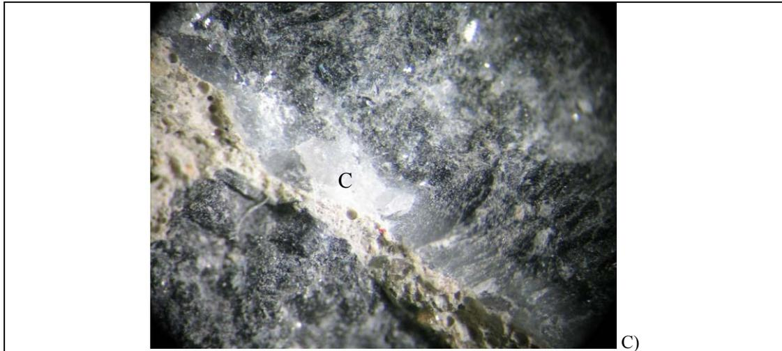
Figura 5.27. Fotomicrografia da amostra 284 P, nota-se fragmentos da rocha 284 (1), agregado miúdo (2) poros e boa aderência no contato fissuras e poros parcialmente preenchidos (3). Imagem por microscopia ótica. A) nX; B) n//. C) Fotografia do prisma de concreto 285 P, vista da faixa de material depositado no contato agregado e argamassa, provável carbonato (C). Imagem por lupa. Aumento de 6,4x.
