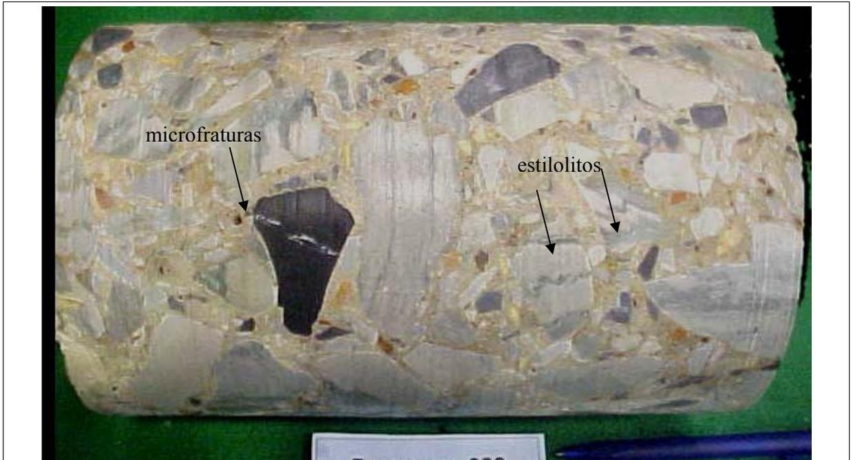
Figura 5.16. Fotografia do testemunho de concreto 335A. Nota-se microfissuras que cortam o agregado e a argamassa. O agregado graúdo é semelhante à rocha 286, notam-se os estilolitos e a granulação muito fina.
