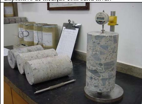
Figura 4.21. Foto do momento da medição do comprimento de referência.
