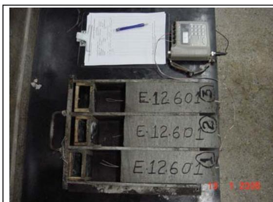
Figura 4.11 – Momento da leitura nos extensômetros dos prismas de concreto moldados.
