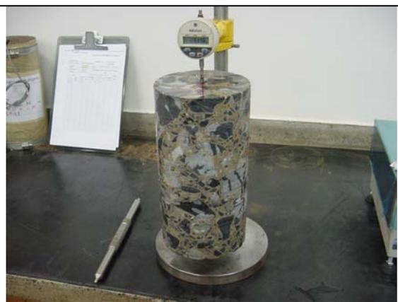
Figura 4.26. Figura do momento da leitura no (corpo-de-prova estocado imerso em água à temperatura de 40°C).
