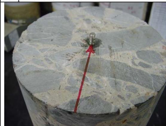
Figura 4.23. Foto do pino de aço inoxidável fixado do topo e base dos testemunhos.
