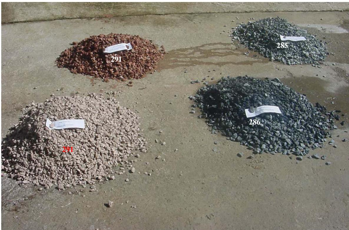
Figura 4.7 – Foto dos agregados carbonáticos 285, 286, 290 e 291, para ilustrar a coloração diferenciada.
