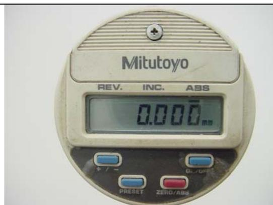
Figura 4.20. Foto do relógio digital utilizado nas medições de variação de comprimento.
