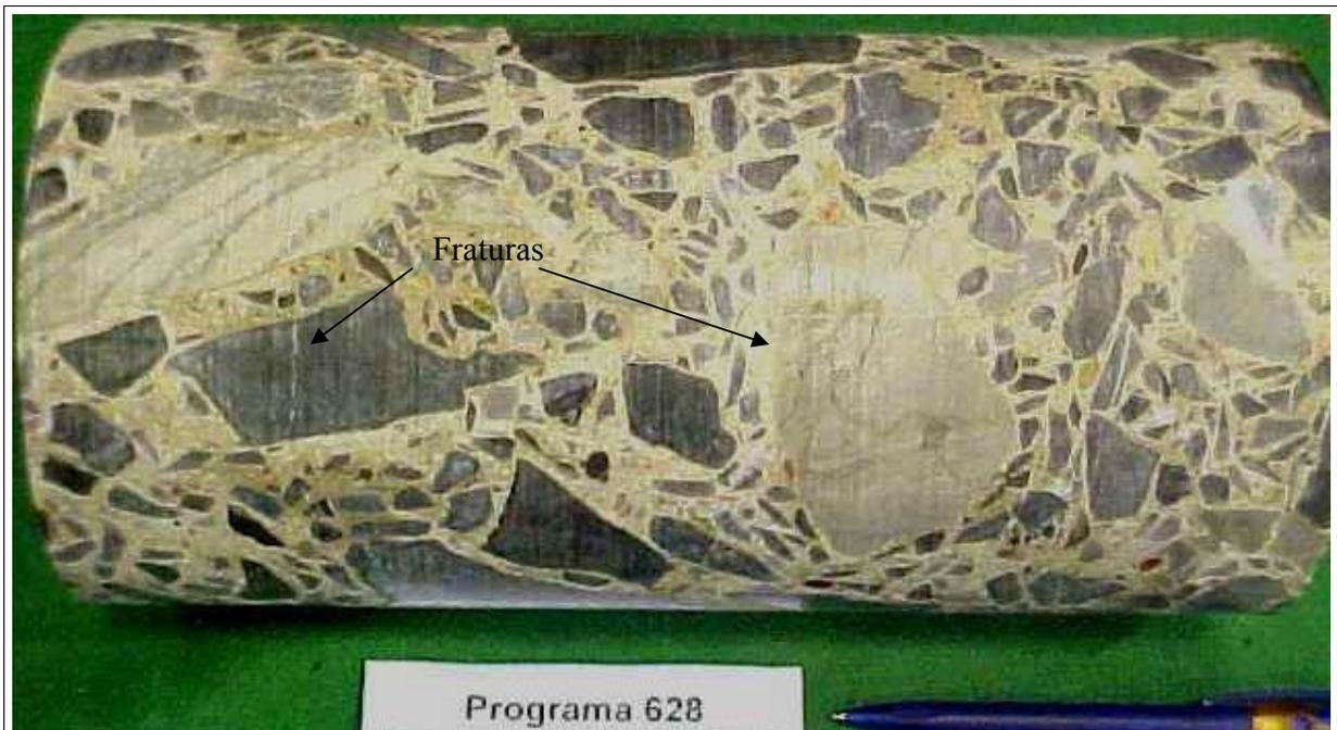
Figura 5.18. Fotografia do testemunho de concreto 335A. Notam-se microfissuras que cortam o agregado e a argamassa. O agregado graúdo é semelhante à rocha 286, notam-se os estilólitos e a granulação muito fina.
