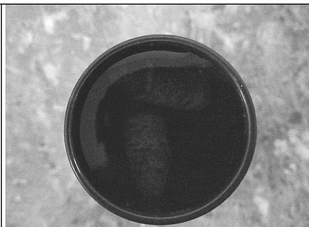
Figura 4.16 – Foto das amostras imersas em recipiente com NaOH a 1 N.
