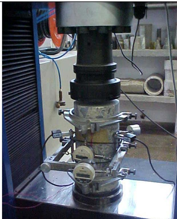
Figura 4.29 – Ensaio de módulo de elasticidade com extensômetro mecânico e elétrico, strain gage colado.
