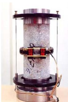
Figura 4.31 – Foto em detalhe da montagem do corpo-de-prova.
