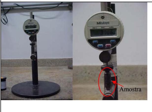
Figura 4.18 – Foto do equipamento de leitura e detalhe do relógio digital, com a amostra.
