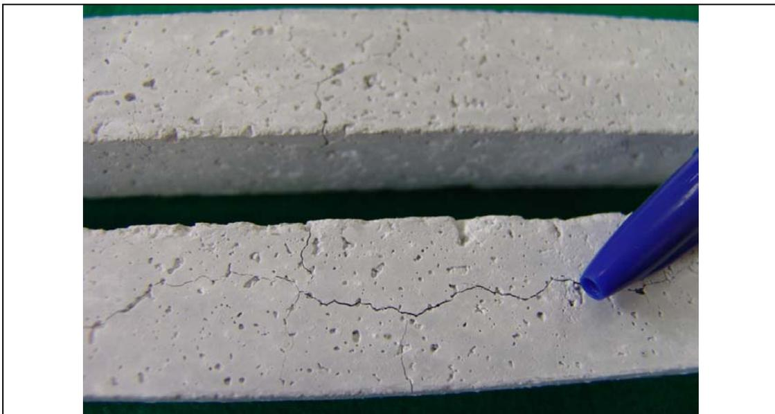
Figura 5.22. Fotografia da barras de argamassa 291B, após ensaio de reatividade. Detalhe das fissuras na barra de argamassa.
