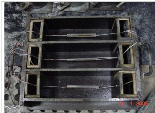
Figura 4.8 – Foto da montagem dos extensômetros nas formas prismáticas.
