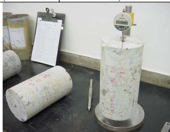
Figura 4.24. Foto do momento da medição do comprimento de referência.
