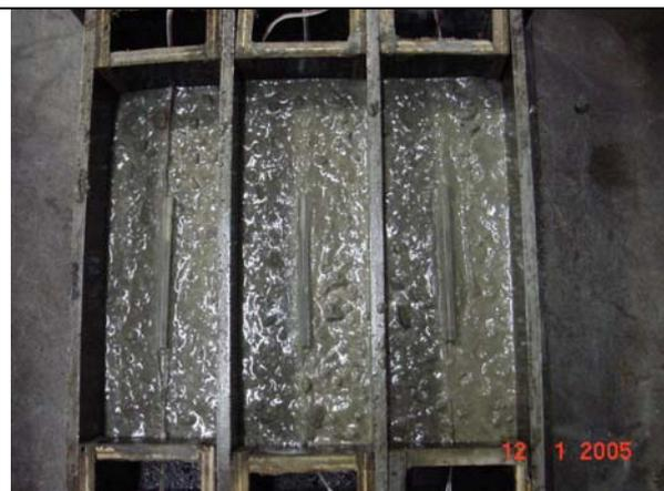
Figura 4.9 – Foto do posicionamento dos extensômetros à meia altura da forma com concreto.
