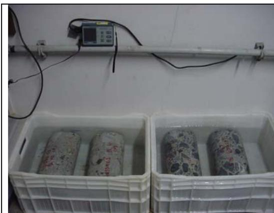
Figura 4.25. Foto dos corpos-de-prova estocados imersos em água à temperatura de 40°C .
