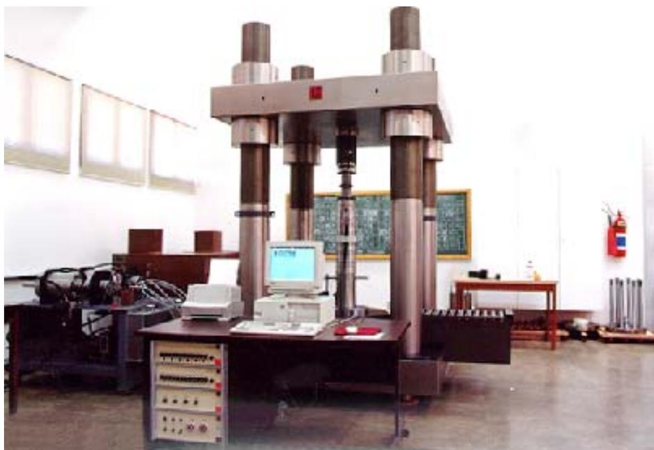
Figura 4.30 – Foto do sistema Servo-Controlado para ensaios de compressão das rochas.
