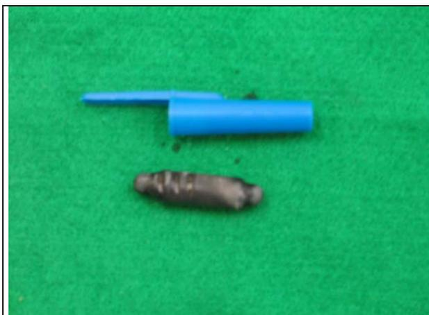
Figura 4.15 – Foto do minitestemunho extraído da rocha carbonática e com suas extremidades torneadas para serem medidas pelo relógio digital.
