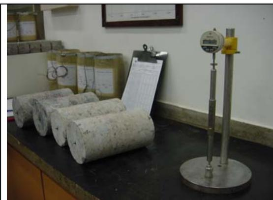
Figura 4.19. Foto dos testemunhos de concreto e dispositivo de medição com barra Invar.
