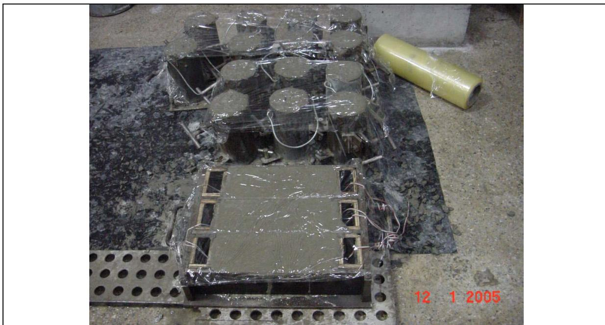
Figura 4.10 – Foto da moldagem e proteção dos corpos-de-prova com plástico (para evitar perda de umidade) até o transporte para a câmara úmida.
