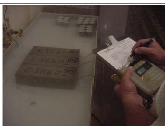
Figura 4.12 – Momento da leitura (de referência, nos CPs imersos em água) nos extensômetros dos prismas de concreto moldados.
