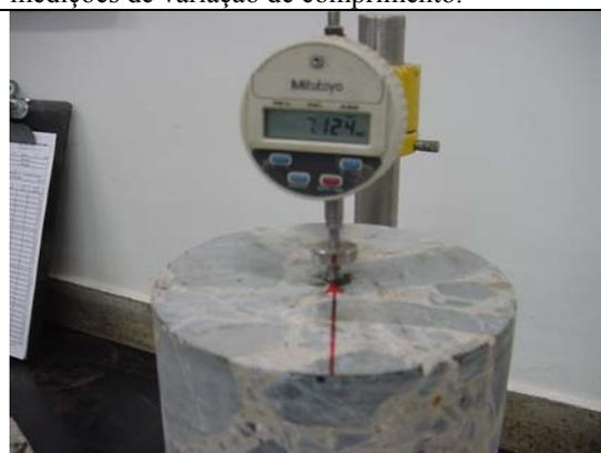
Figura 4.22. Foto ilustrando o ponto de referência (alinhamento do pino fixado no CP) das leituras.
