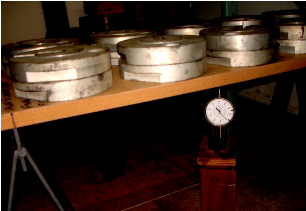
Figura 14. Ensaio de flexão em prateleiras.
