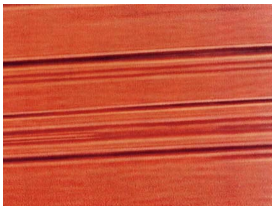
Figura IV.7 – Transição gás-líquido obtida 32 por meio da aplicação de campo magnético em amostra básica de EDL-MF à base maguemita com 12 nm de diâmetro. A transição foi observada com um microscópio ótico em campo magnético com módulo ligeiramente inferior a 0,1 T.
