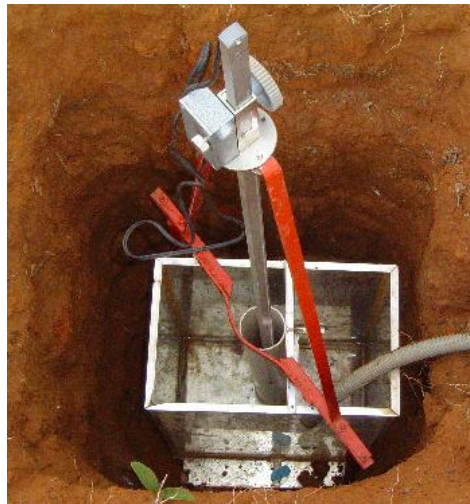
Figura 3.12 – Equipamento para quantificação do volume de escoamento superficial posicionado no local do experimento.
