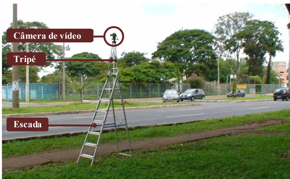
**Figura 5.7:** Adaptação da filmadora para coleta de dados
