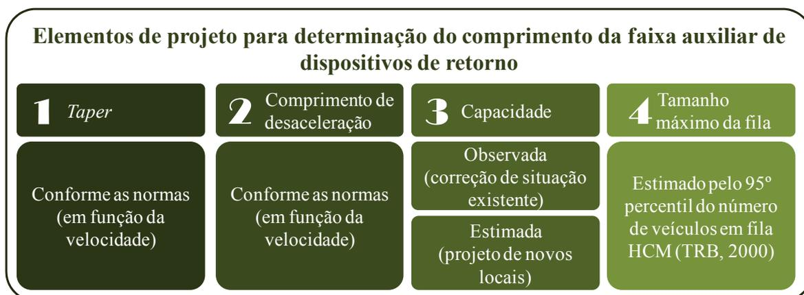
**Figura 6.9:** Etapas do procedimento para determinação do comprimento da faixa auxiliar de dispositivos de retorno
