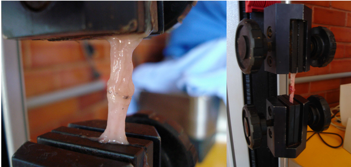
FIGURA 17 – POSICIONAMENTO DO SEGMENTO DE CÓLON A SER TESTADO NO TENSÍMETRO COM A LINHA DE ANASTOMOSE AO CENTRO (A) E (B).
