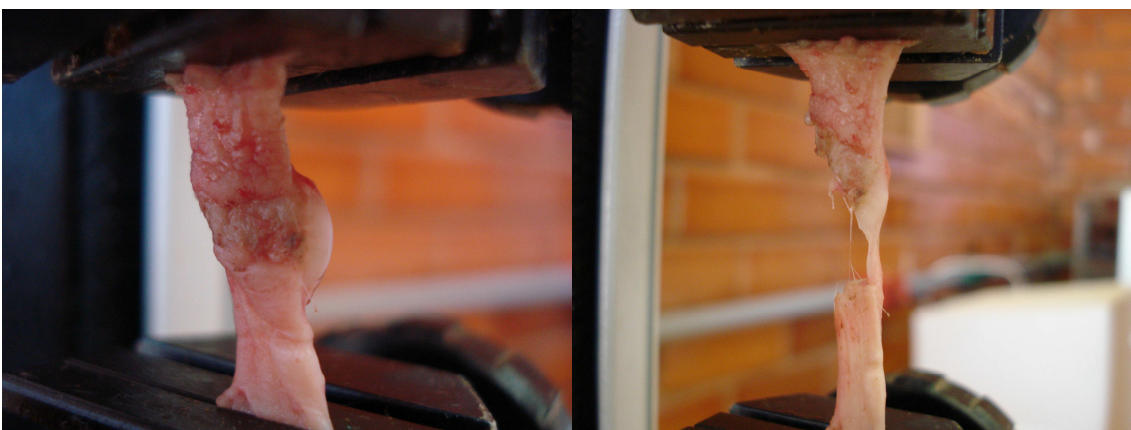
FIGURA 18 – SEGMENTO DE CÓLON JÁ POSICIONADO NO TENSÍMETRO (A) E ROTURA DO SEGMENTO DE CÓLON TESTADO (B).
