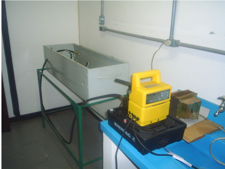
Figura 3.22 – Bancada de ensaios com a bomba hidráulica e a mangueira reforçada
