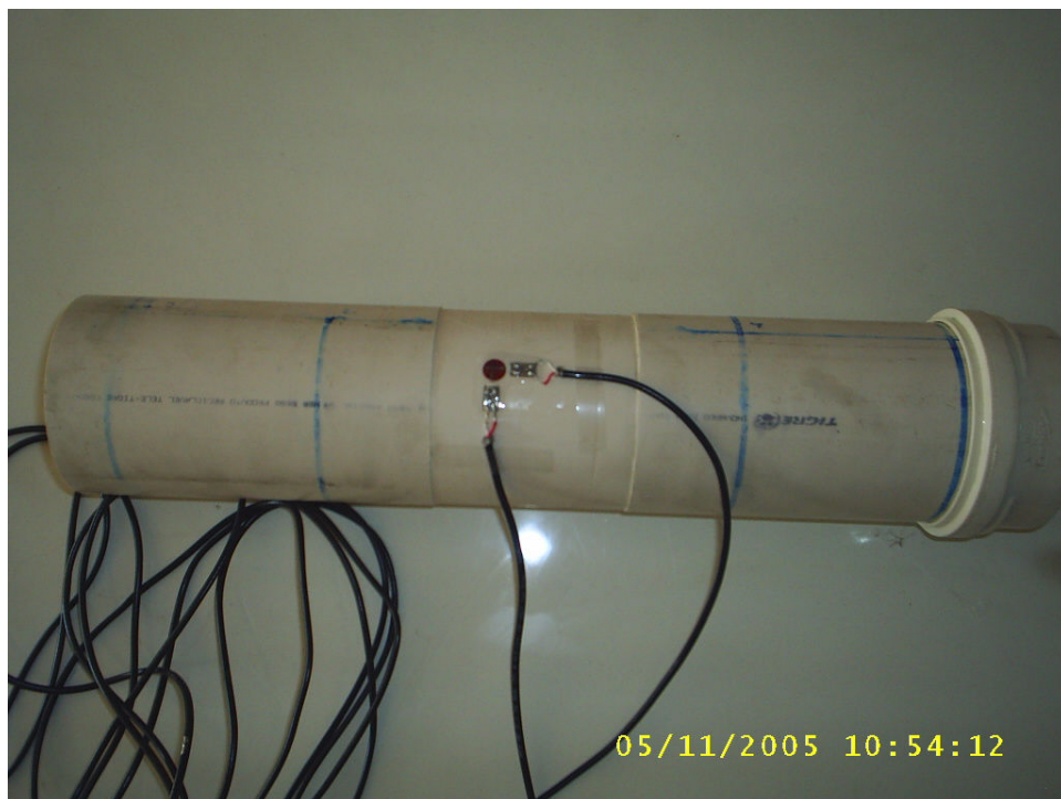
Figura 3.18 – Localização e direção dos extensômetros (roseta) nos CP's n os 3 e 4
