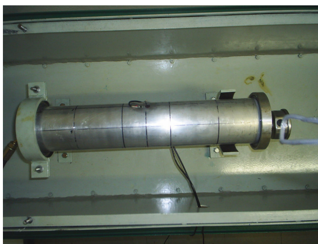
Figura 3.23 - Tubo íntegro de alumínio pressurizado até 0,6 MPa, no regime elástico
