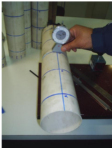
Figura 3.6 - Medição do parâmetro, \delta , de variação de raio, com o esferômetro
