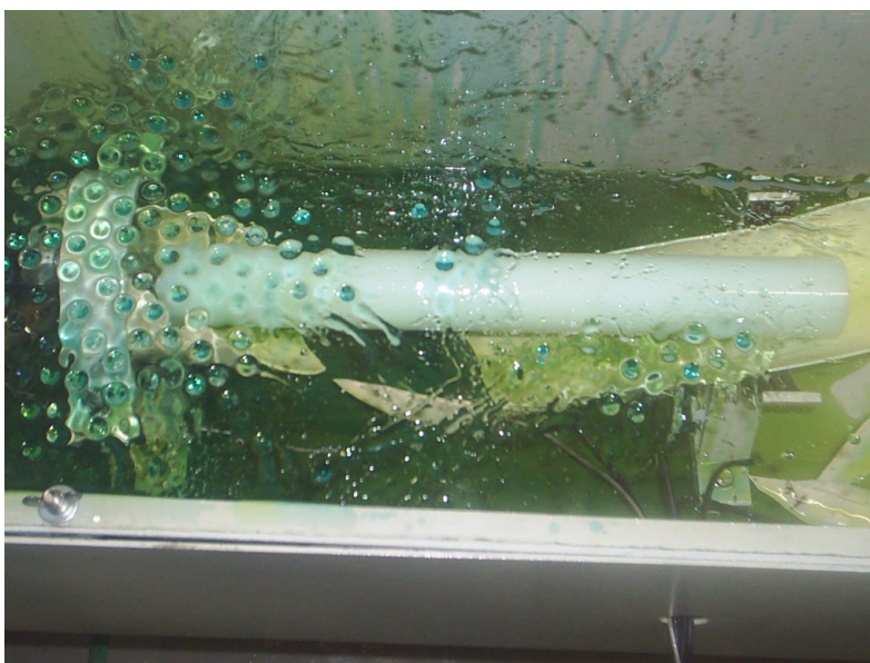
Figura 3.24 – CP nº1 de tubo íntegro de PVC rompido a p = 1,4 MPa
