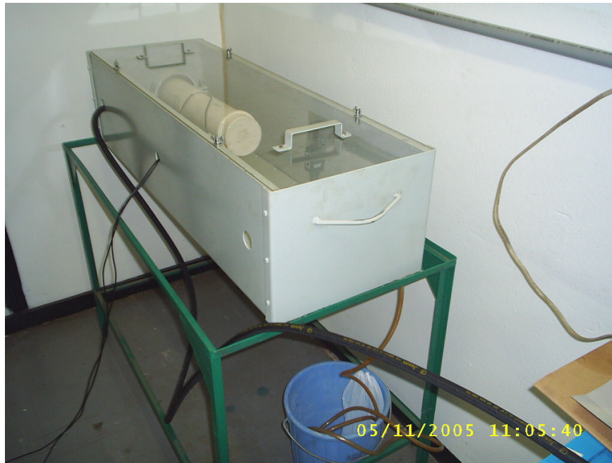
Figura 3.14 – Bancada de ensaios com tampa acrílica de 5 mm de espessura
