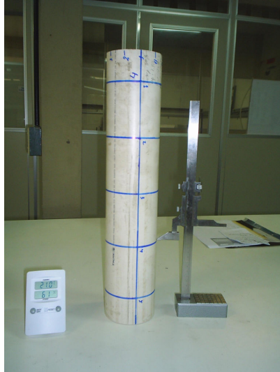
Figura 3.5 – Traçado das linhas circunferenciais com paquímetro de altura
