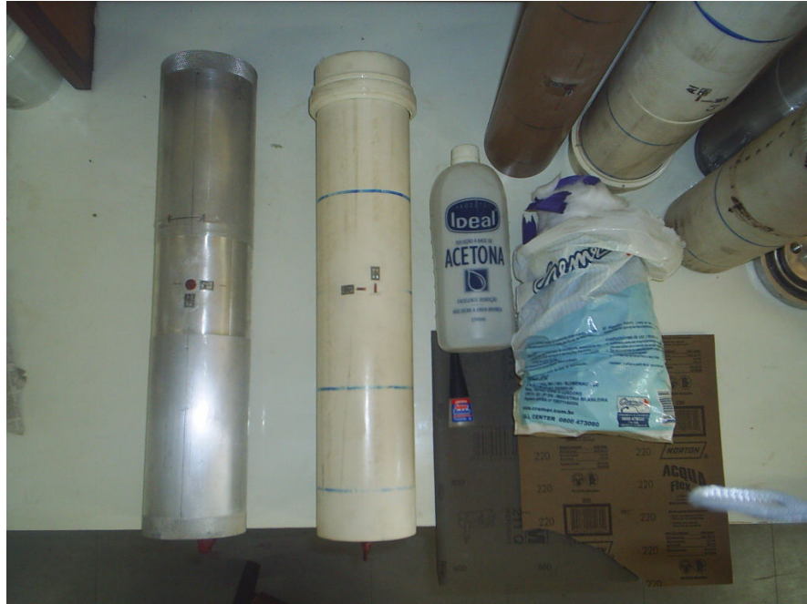
Figura 3.16 – Processo de colagem dos extensômetros tipo roseta (tubo de alumínio) e tipo unidirecional (tubo de PVC)
