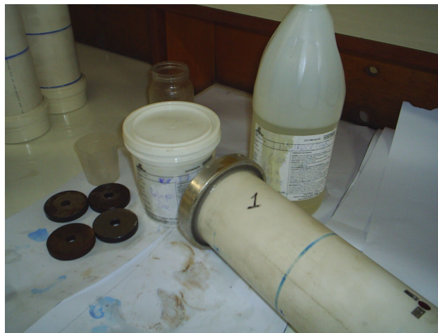
Figura 3.11 – Tampa encaixada no tubo de PVC e colada com araldite industrial
