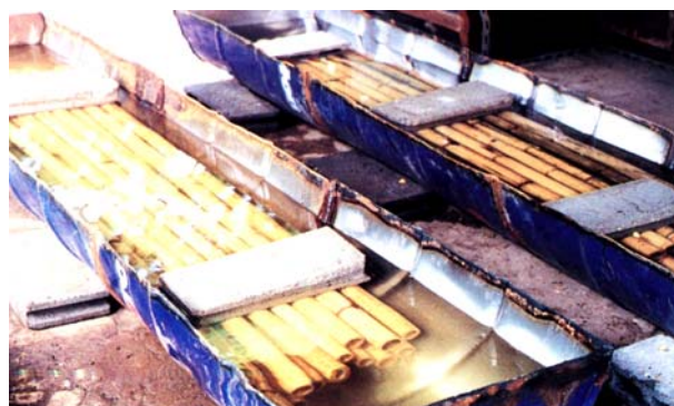
Figura 35 - Tratamento das varas pelo método de imersão em produtos químicos (IL31 BAMBOO, 1992, p.46).
