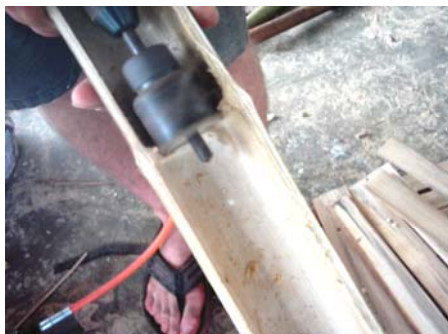
Figura 135 - Utiliza-se uma retífica elétrica para aplainar as paredes internas do bambu.
