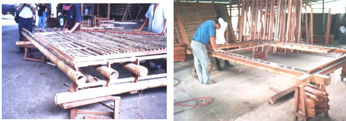
Figura 93 - (a) Gabarito para a produção do painel; (b) Montagem do painel. (Fonte: Foto da autora, San José, Costa Rica, 1998).
