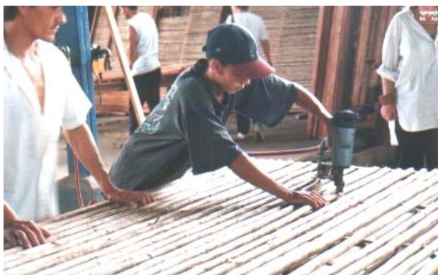
Figura 94 - O uso de grampeador para a fixação das varas de bambu. (Fonte: Foto da autora, San José, Costa Rica, 1998).
