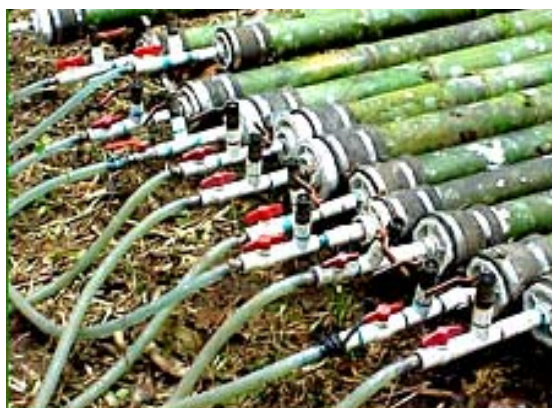
Figura 34 - Aplicação do método Boucherie em varas de bambu. (Fonte: Foto da autora. Costa Rica, 1998).
