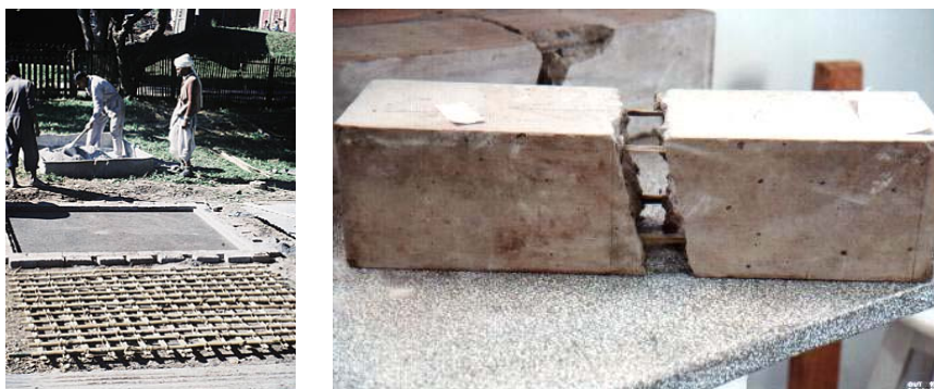
Figura 27 - (a) e (b) O uso do bambu substituindo as armaduras de aço na produção do concreto. (Fonte: CD-Rom cedido por Roberto Magno).
