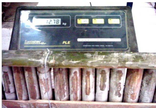
Figura 156 - Estrutura de bambu sendo pesada antes da aplicação de chapisco e argamassa, registrando o peso de 12,78 kg. (Fonte: Foto da autora, 2005).
