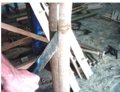
Figura 133 - Abre-se manualmente o bambu para a produção das molduras. (Fonte: Foto da autora, tirada durante a etapa de execução, 2005).
