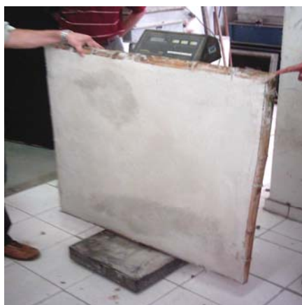
Figura 169 - Pesagem de um painel. (Fonte: Foto da autora, 2005)
