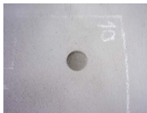
Figura 179 - (a) e (b) Arrancamento da pastilha metálica utilizada no ensaio. (Fonte: Foto da autora, 2005)
