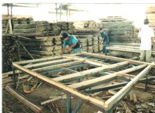
Figura 99 - Produção dos quadros de madeira, a estrutura do painel. (Fonte: Foto de Ana Maria França. Hogar de Cristo, Equador, 2001).
