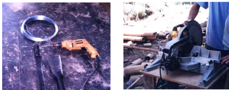
Figura 143 - (a) Ferramentas simples utilizadas na execução dos painéis; (b) Serra circular, equipamento apropriado para o corte dos bambus. (Fonte: Foto da autora, tirada durante a etapa de execução, 2005).
