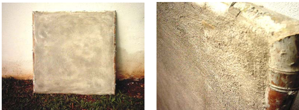
Figura 163 - (a) Corpo-de-prova finalizado, após a secagem da argamassa de revestimento; (b) Detalhe do corpo-de-prova após a secagem da argamassa. (Fonte: Foto da autora, 2005).
