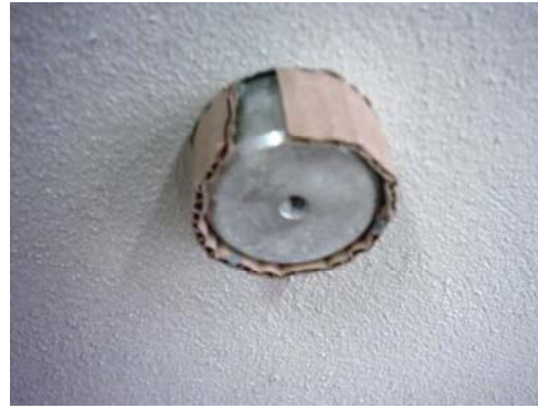
Figura 177 - (a) Pastilhas metálicas aderidas ao corpo-de-prova para realização do ensaio de aderência; (b) detalhe da pastilha metálica. (Fonte: Foto da autora, 2005)
