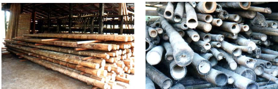
Figura 30 - (a) Armazenamento correto das varas de bambu (IL31 BAMBOO, 1992, p.87); (b) Armazenamento incorreto das varas de bambu. (Fonte: Foto de Roberto Magno).
