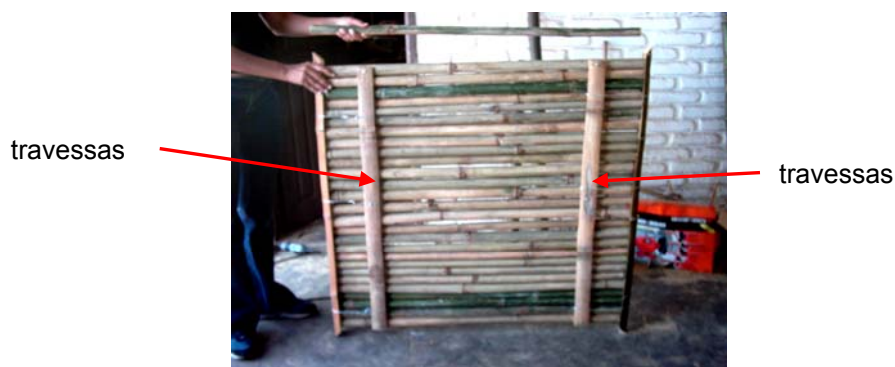
Figura 142 - Travessas de estabilização da estrutura do corpo-de-prova. (Fonte: Foto da autora, tirada durante a etapa de execução, 2005).
