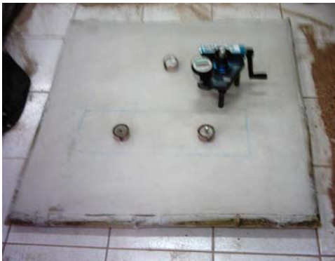
Figura 178 - (a) e (b) Realização do ensaio de tração da aderência, com uso de equipamento apropriado. ( Fonte: Foto da autora, 2005)
