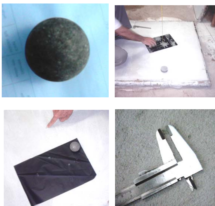
Figura 171 - Avaliação da dureza superficial do painel. ( Fonte: Foto da autora, 2005)
