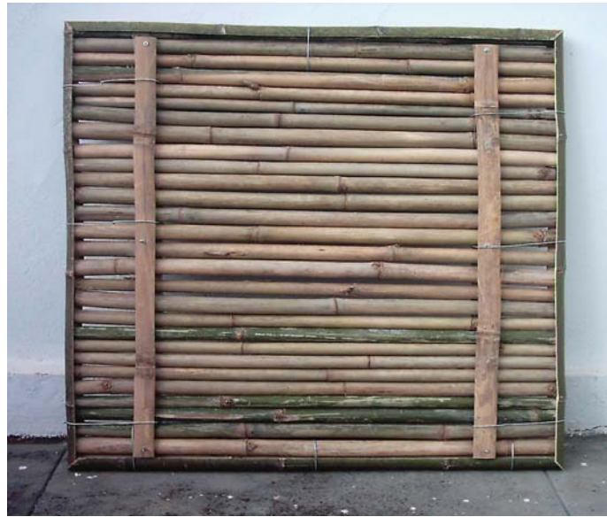
Figura 150 - Estrutura do corpo-de-prova finalizada. (Fonte: Foto da autora, tirada durante a etapa de execução, 2005).
