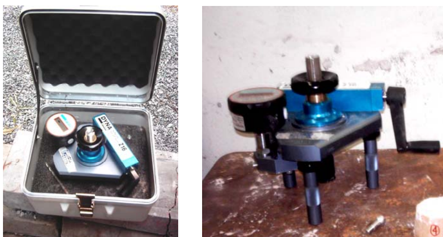
Figura 175 - Equipamento empregado para aplicar a tensão de tração. (Fonte: Foto da autora, 2005)
