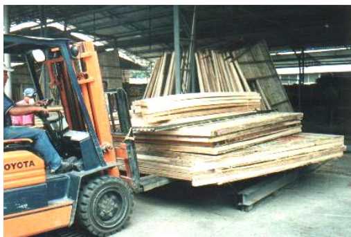
Figura 102 - Kit casa pronta sendo armazenado no interior da fábrica. (Fonte: Foto de Ana Maria França. Hogar de Cristo, Equador, 2001).
