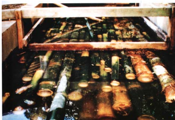
Figura 32 - Cura pelo método de banho quente e frio (IL31 BAMBOO, 1992, p. 76).
