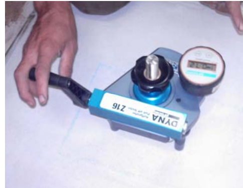
Figura 178 - (a) e (b) Realização do ensaio de tração da aderência, com uso de equipamento apropriado. ( Fonte: Foto da autora, 2005)
