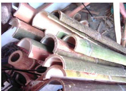
Figura 134 - Bambu para moldura cortado em meia-cana. (Fonte: Foto da autora, tirada durante a etapa de execução, 2005).
