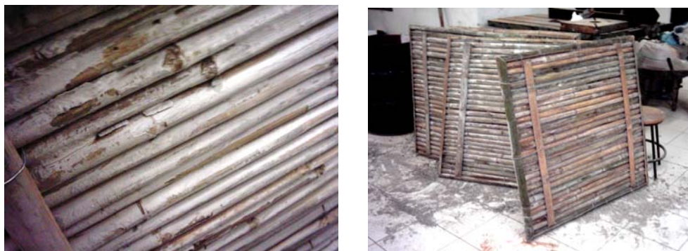
Figura 155 - (a) Pasta de cimento aderida ao bambu, após a mineralização; (b) As cascas despregam-se facilmente e caem ao chão. (Fonte: Foto da autora, 2005).
