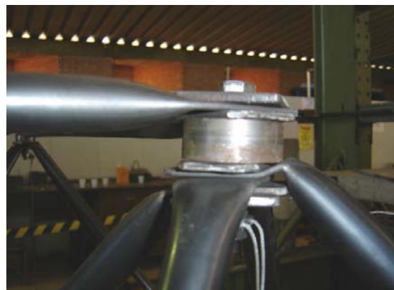
Figura 5.59 – Deformada da ligação com carga de 25kN – Protótipo LTDCE2
