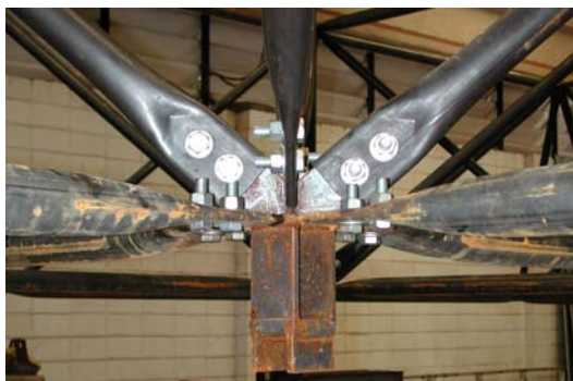
Figura 2.65 – Detalhe da ligação com nó de aço (Souza, 2003)
