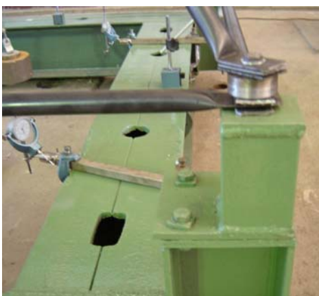
Figura 5.2 – Fixação dos protótipos na base com apoio de ligação
