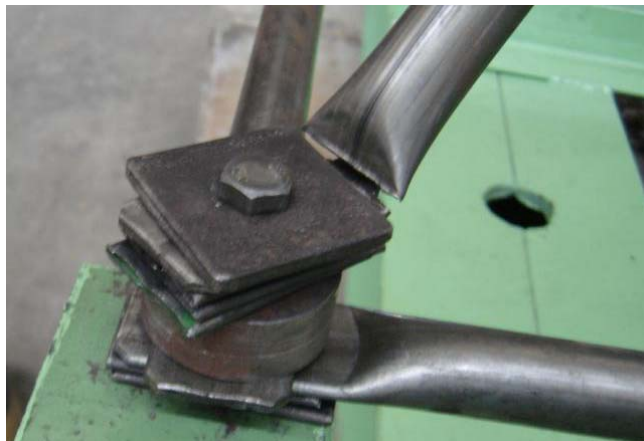
Figura 6.22 – Detalhe da ruptura da diagonal no ensaio do protótipo LTDCD3
