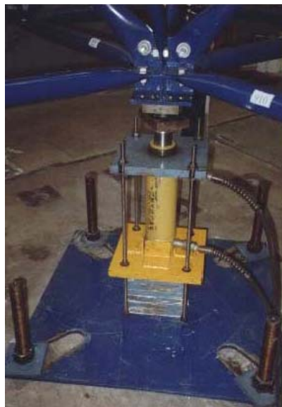
Figura 2.58 – Nó de aplicação de carga e nó de apoio da estrutura (Silva, 1999)
