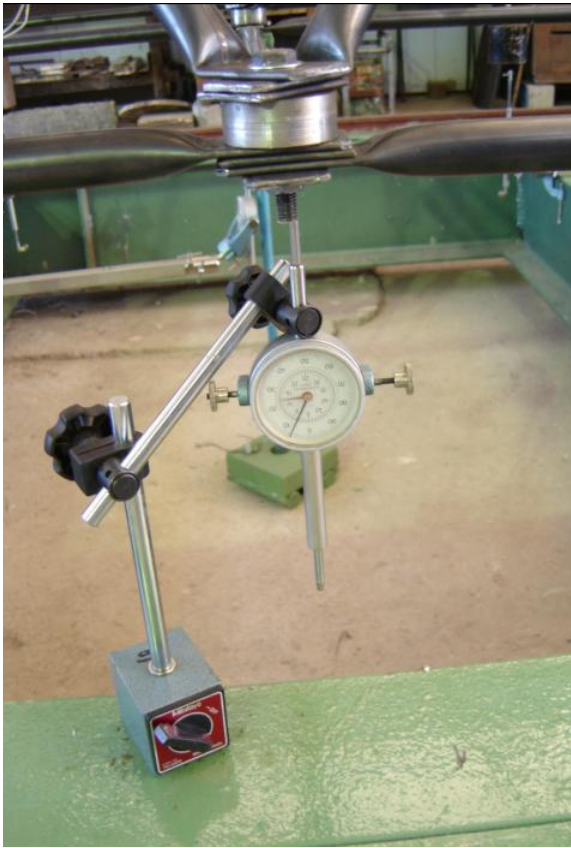
Figura 5.10 – Instrumentação dos nós 1, 2, 3 e 4 (base de leitura)
