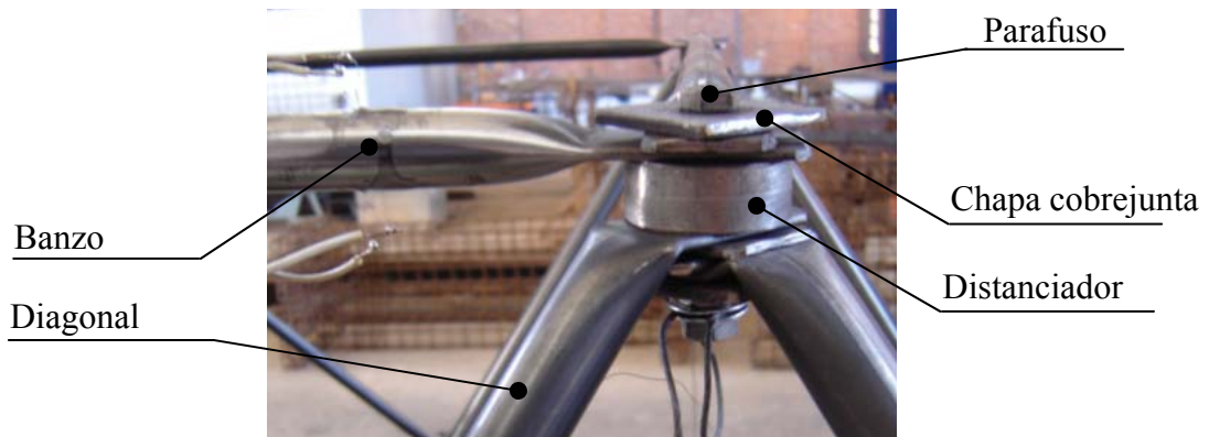
Figura 5.21 – Ligação típica com distanciador e cobrejunta - LTDCE
