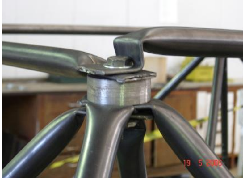
Figura 5.52 – Colapso global da estrutura com carga de 40kN – Protótipo LTDE2
