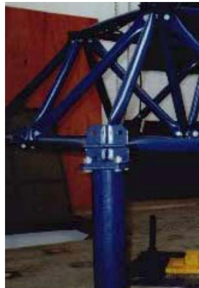
Figura 2.58 – Nó de aplicação de carga e nó de apoio da estrutura (Silva, 1999)
