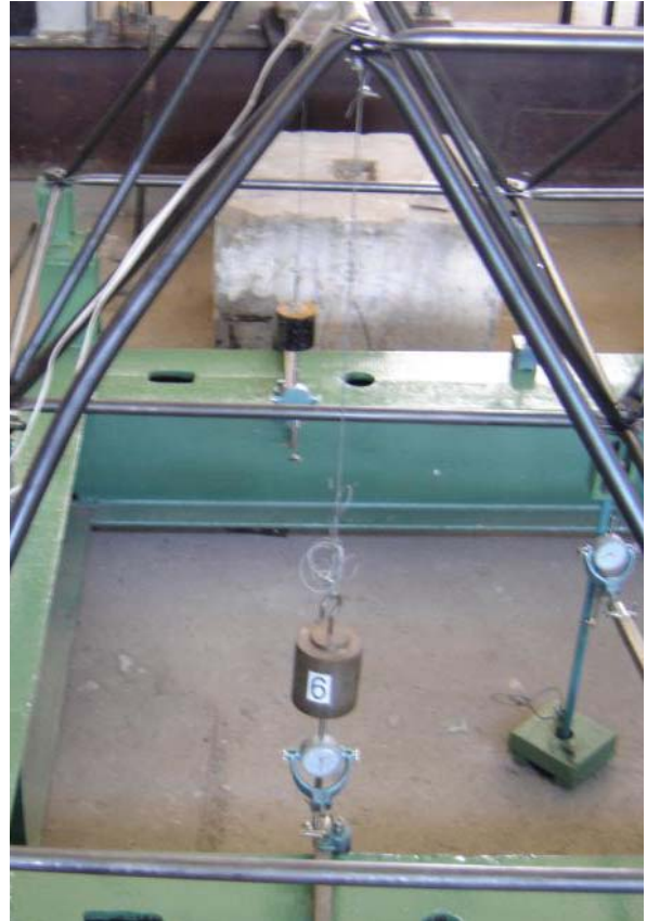
Figura 5.11 – Instrumentação dos nós 5, 6, 7 e 8 (pêndulo)
