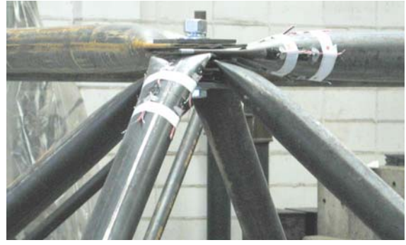
Figura 2.63 – Detalhe da ligação com nó típico (Souza, 2003)
