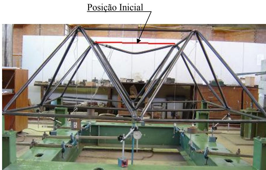
Figura 5.38 – Colapso global da estrutura com carga de 35,9kN – Protótipo LTE2
