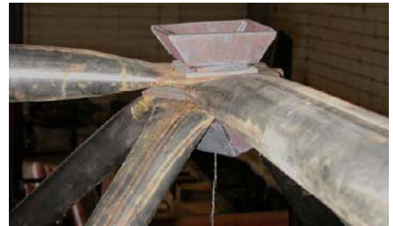
Figura 2.64 – Detalhe do nó típico com reforço proposto (Souza, 2003)
