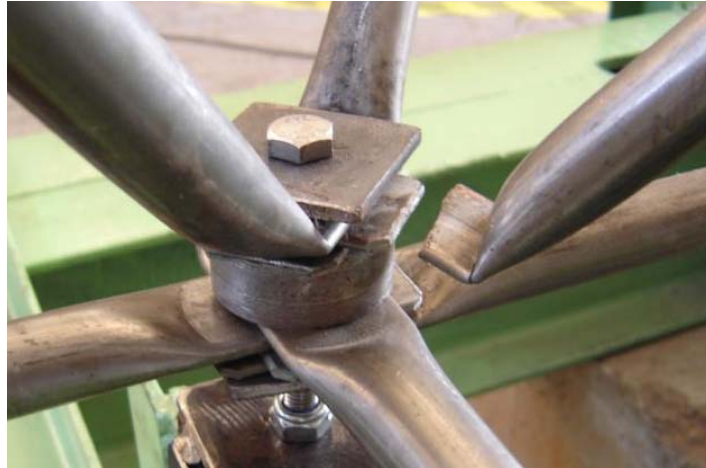
Figura 6.23 – Detalhe da ruptura da diagonal no ensaio do protótipo LTDCD4
