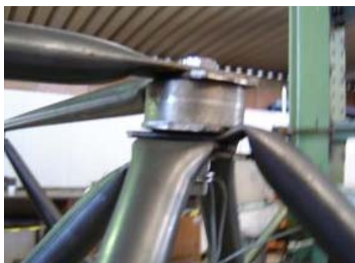
Figura 5.44 – Deformada da ligação com carga de 25kN – Protótipo LTDE1
