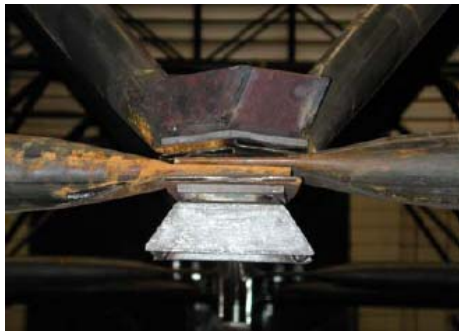
Figura 2.64 – Detalhe do nó típico com reforço proposto (Souza, 2003)
