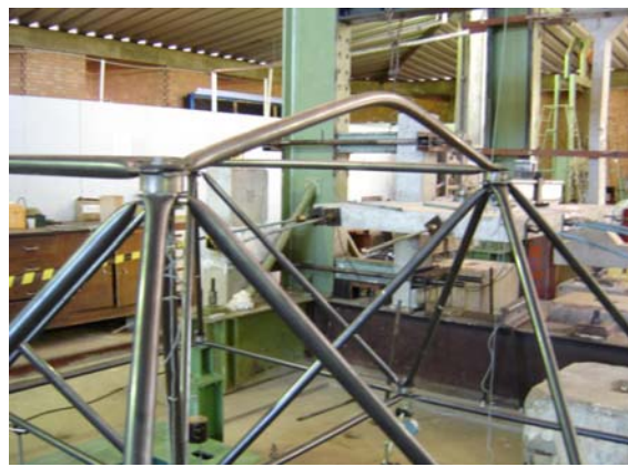
Figura 5.75 – Colapso da LTDCE
