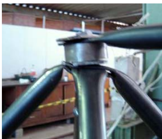
Figura 5.46 – Deformada da ligação com carga de 25kN – Protótipo LTDE3
