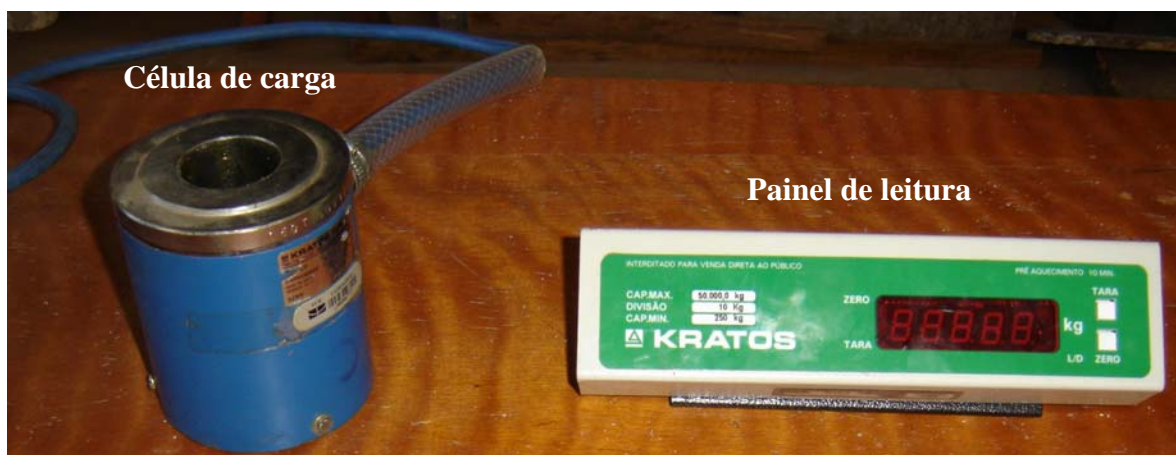
Figura 5.8 – Sistema de aquisição do carregamento com célula de carga
