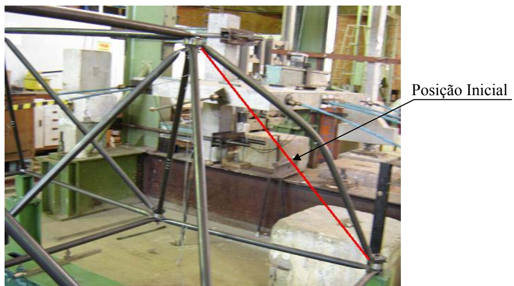
Figura 5.65 – Colapso global da estrutura com carga de 42,7kN – Protótipo LTDCE1
