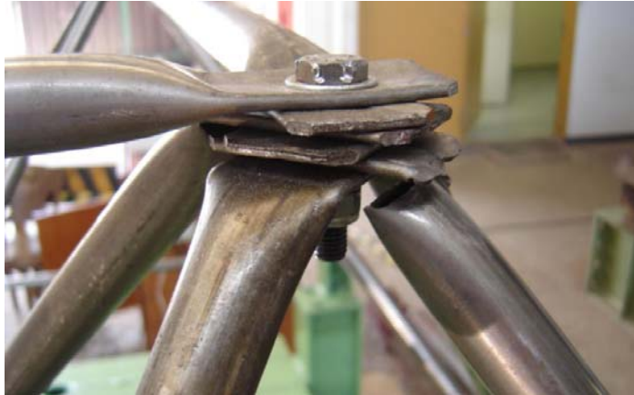
Figura 6.16 – Detalhe da ruptura da diagonal no ensaio do protótipo LTD2
