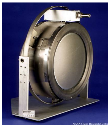
Figura 1.2: Propulsor tipo Kaufman. Note a presença de grades para extração e aceleração do plasma.
