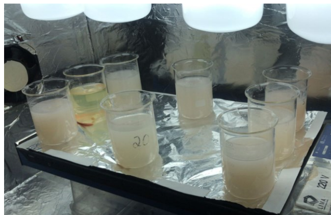
Figura 32: Aparência de uma das bateladas de fotocatalise do resíduo de RhB após 24.
