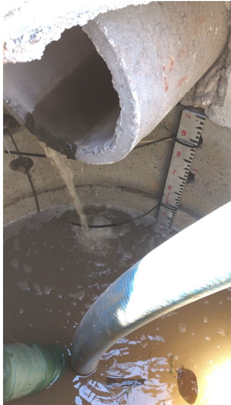
Figura 5.39: Registro da ocorrência de vazões na rede durante o ensaio em campo.
