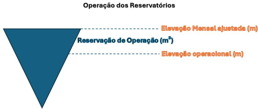
Figura 3.3 – Representação da operação dos reservatórios de acumulação no WEAP.
