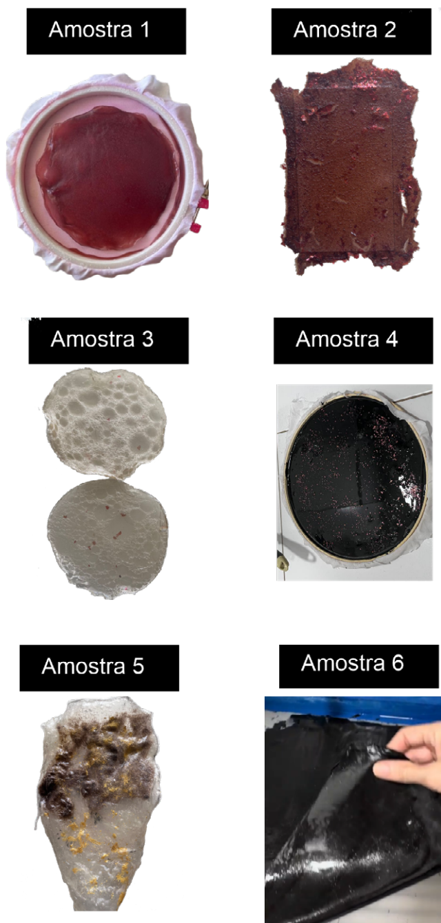
Figura 10 - Da esquerda para direita: Primeiros experimentos - Amostra 1: Alginato com Crajiru; Amostra 2: Agar sem lã; Amostra 3: Bioespuma de gelatina; Amostra 4: Alginato de sódio com carvão ativado; Amostra 5: Fécula de batata com lã; Amostra 6: Alginato com carvão ativado em formato maior.
