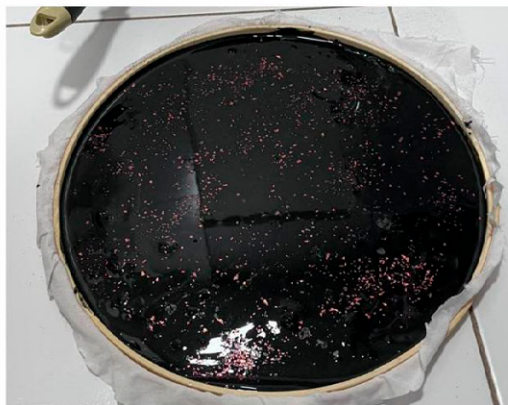
Figura 7. Amostras de biomaterial de alginato com carvão ativado em processo de secagem com a descrição da fórmula final.
