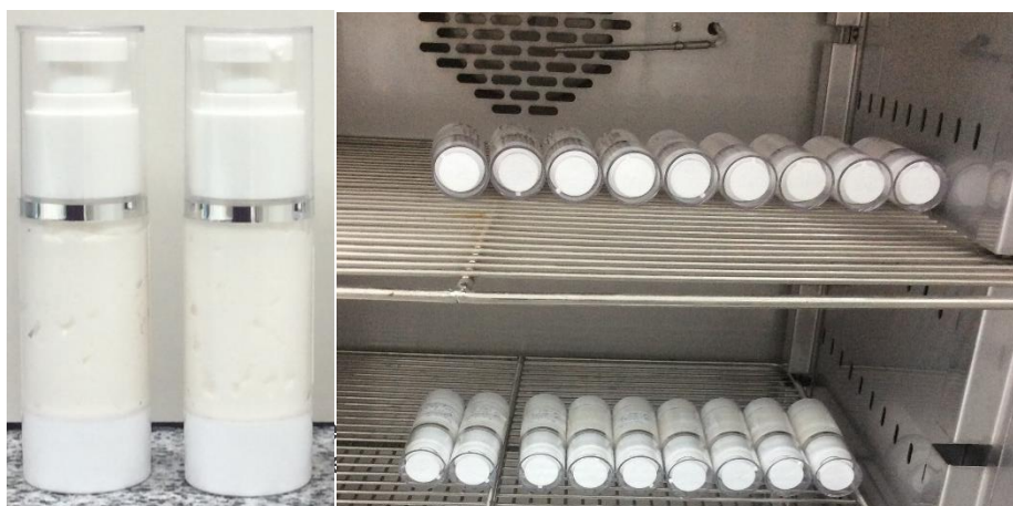
Figura 17 Armazenamento das emulsões em frascos airless. A – airless com BHT; B - airless sem BHT. Imagem da própria autora.
