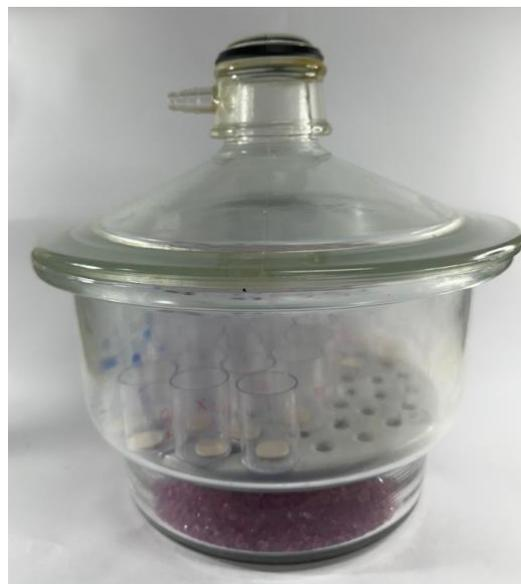
*Figura 10 – Dissecadora contendo sílica gel*
