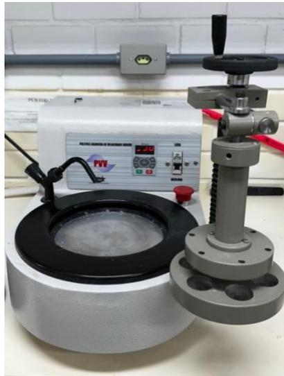
*Figura 13 – Politriz metalográfica de velocidade variável*
