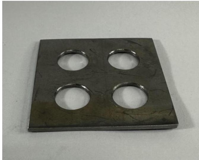
*Figura 9 – molde metálico para confecção das amostras*
