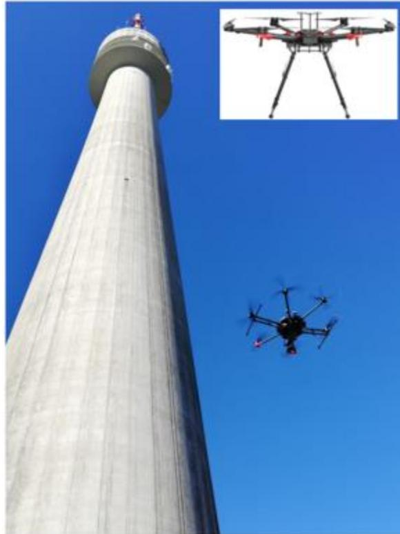
Figura 2.2 - Coleta de imagens do UAV (Unmanned Aerial Vehicles) ou drone, modelo DJI Matrice 600 Pro em operação. (D. Ribeiro,2020).
