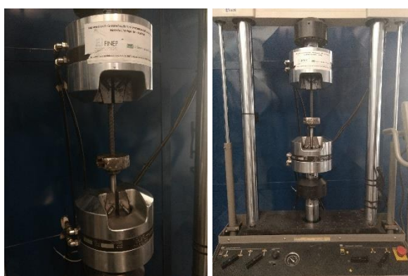
Figura 3.15 - Ensaio para análise da resistência à tração do conector com cabeça
