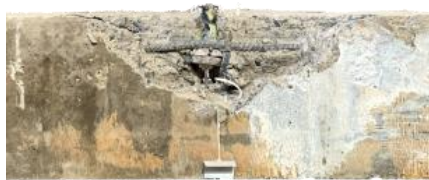
Figura 4.36 - Superfície de ruptura dos espécimes – G4
