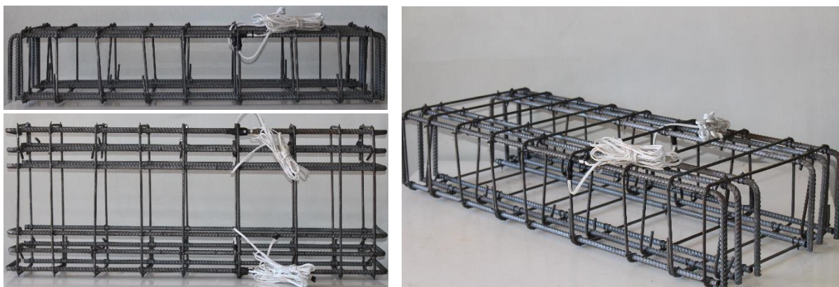
Figura 3.16 - Detalhe das armaduras do espécime H-120-0,45-3-S
