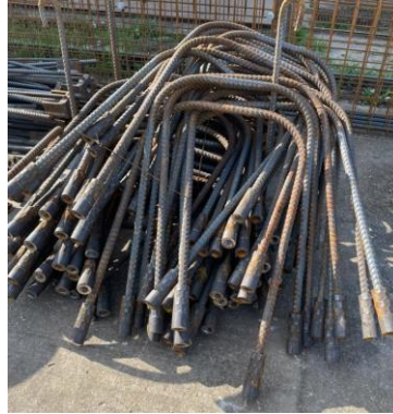
Figura 3.2 - Conectores “U” usados como base para idealizar aqueles desta pesquisa
