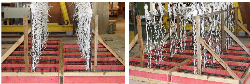
Figura 3.10 - Formas utilizadas para moldagem dos prismas de concreto
