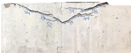
Figura 4.35 - Superfície de ruptura dos espécimes – G3
