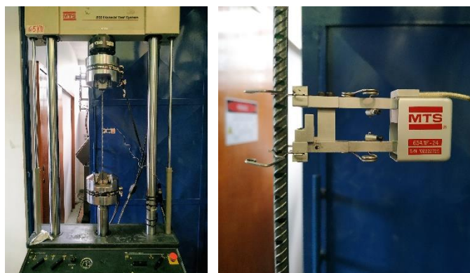
Figura 3.14 - Ensaio de tração para determinação das propriedades mecânicas do aço.
