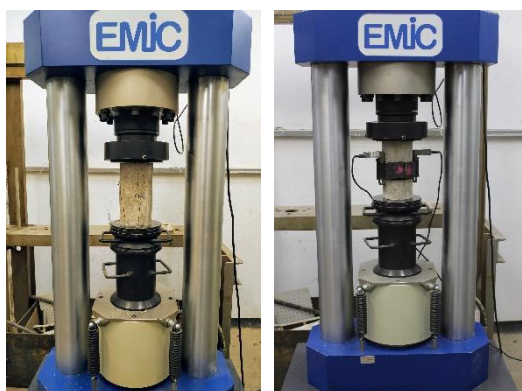
Figura 3.12 - Ensaios de módulo, resistência à compressão e tração do concreto.
