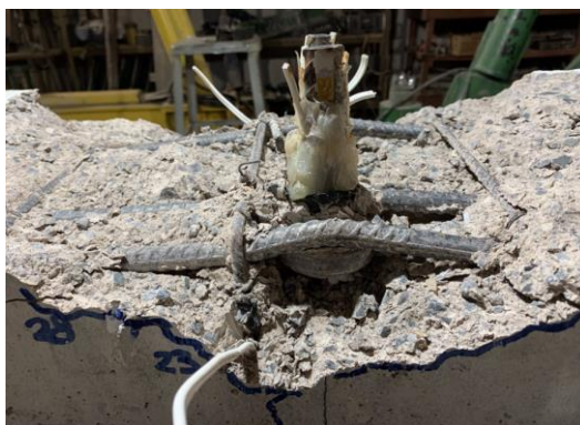
Figura 4.24 - Deformação local da armadura longitudinal do espécime H-60-0,85-3-S.
