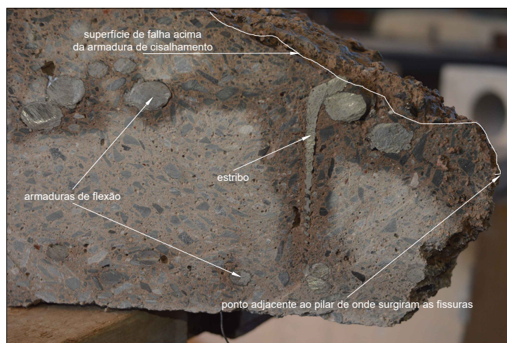
Figura 5.1 – Visual da superfície de ruptura da laje LFE3
