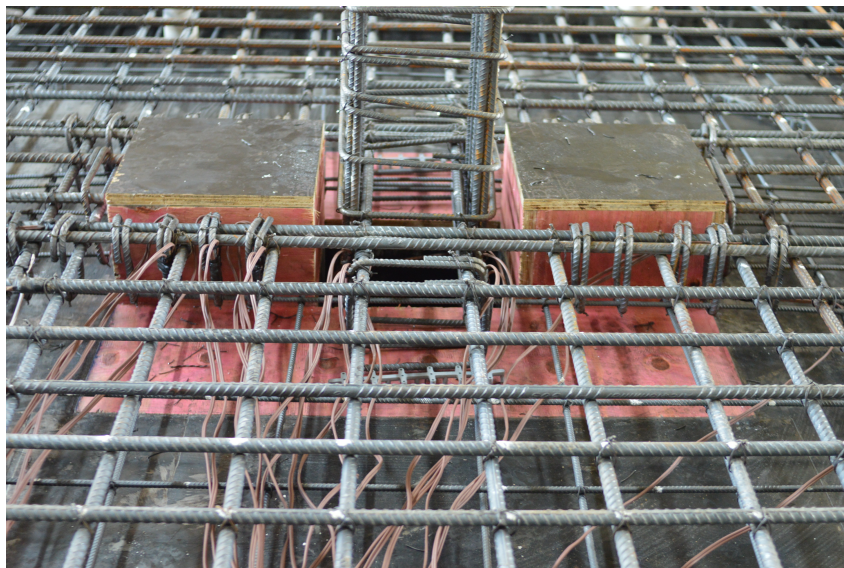
Figura 3.11 – Fotografia das armaduras da laje LFE2 antes da concretagem
