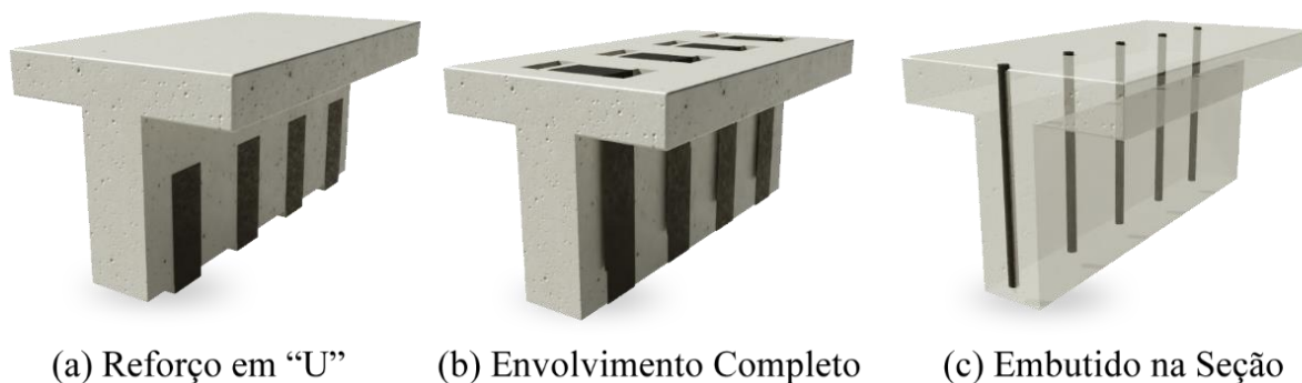
Figura 2.1 – Tipos de reforço ao cisalhamento com FRP
