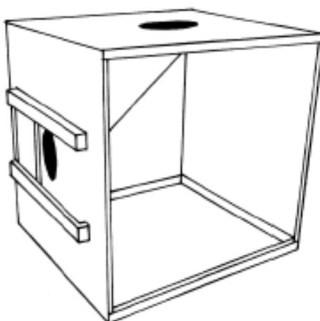
Figura 1. O aparelho da caixa de slides. Aqui a porta desliza para a esquerda, revelando o buraco de onde a recompensa pode ser retirada. Veja o texto para mais informações.
