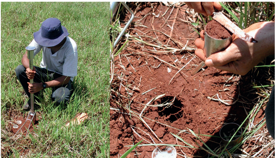
Figura 11.1: Coleta de solos utilizando trado para amostras indeformadas (esquerda) e anel interno retirado com o auxílio do trado (direita) (Campo Grande-MS)
