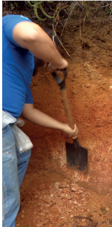
Figura 9.2: Limpeza de perfil de solo com pá reta
