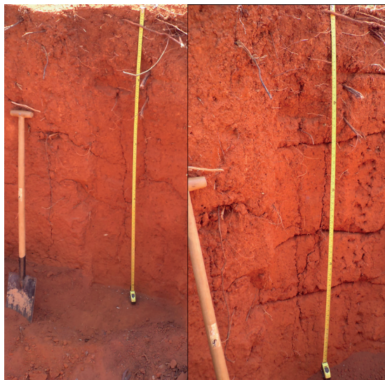
Figura 9.3: Perfil do solo antes (esquerda) e depois (direita) da marcação preliminar dos horizontes (linhas verticais traçadas na superfície do perfil) e teste de consistência (sequência de pequenos buracos ao longo do perfil, à direita da trena)
