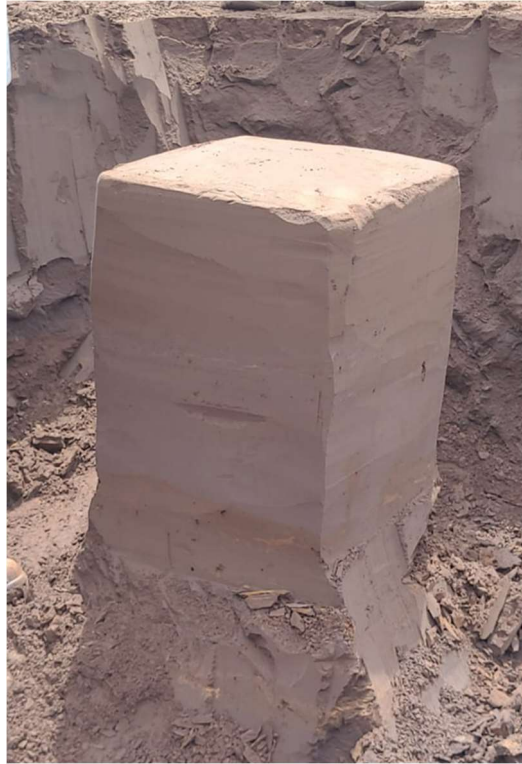
Figura 3-9 – Amostra indeformada coletada em campo na pista teste do rejeito filtrado de flotação. Fonte: o autor
