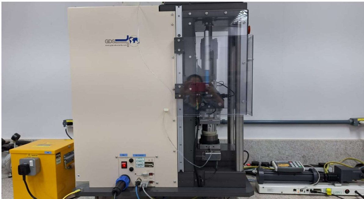
Figura 3-15 – Aparelho para execução dos ensaios DSS, Laboratório de Geotecnia, Vale, CDM. – Fonte : o autor
