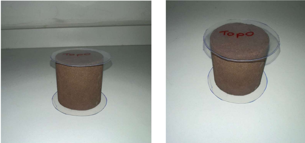
Figura 3-13 – Amostra reconstituída pelo método de Moist Taimping , para utilização nos ensaios de MEV e Porosimetria por Intrusão de Nitrogênio. Fonte: o autor.
