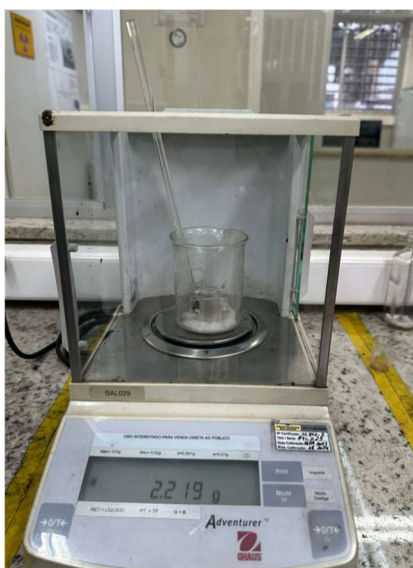
Figura 3-18 – Pesagem da amostra de rejeito de flotação. Fonte: o autor
