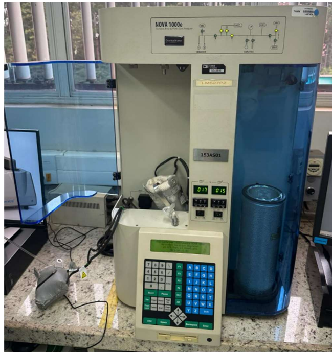
Figura 3-19 – Porosímetro por adsorção de nitrogênio. Fonte: o autor
