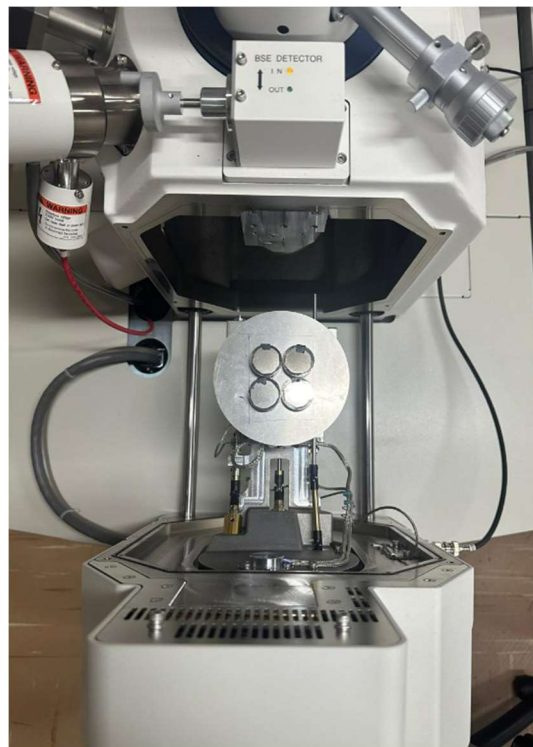
Figura 3-24 - MEV FEI Inspect F50 – Laboratório de mineralogia Vale – Fonte: o autor
