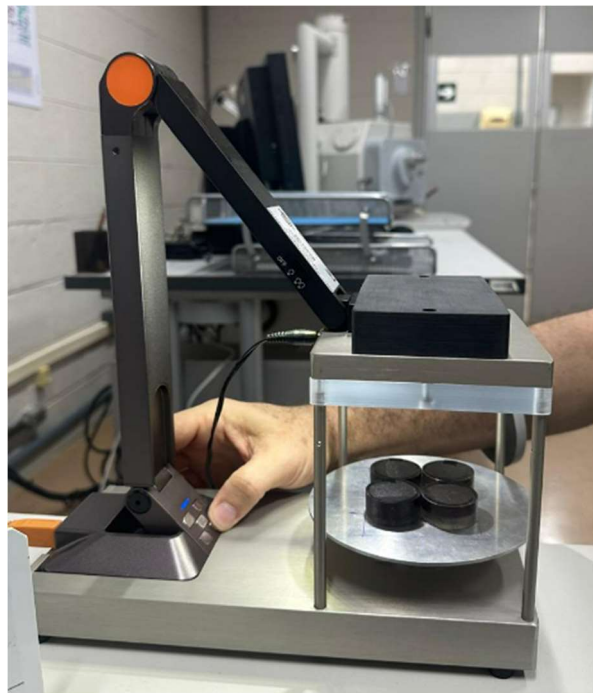
Figura 3-22 – Posicionamento das seções polidas para identificação e organização, etapa anterior ao posicionamento das amostras no MEV. Fonte : o autor.
