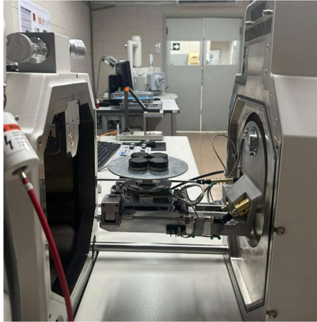
Figura 3-23 – Seções polidas após aplicação de resina, posicionadas no equipamento para ensaio MEV. Fonte : o autor
