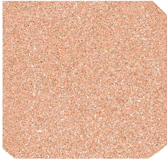
Figura 4-30 – Visão Geral - Imagens Mineralógicas – Técnica QEMSCAN – Amostra AIC
