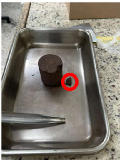
Figura 3-17 – Retirada de pequena “lasca” de um dos corpos de prova a serem ensaiados, indicada pelo círculo vermelho, para posicionamento no porta-amostras. Fonte : o autor.
