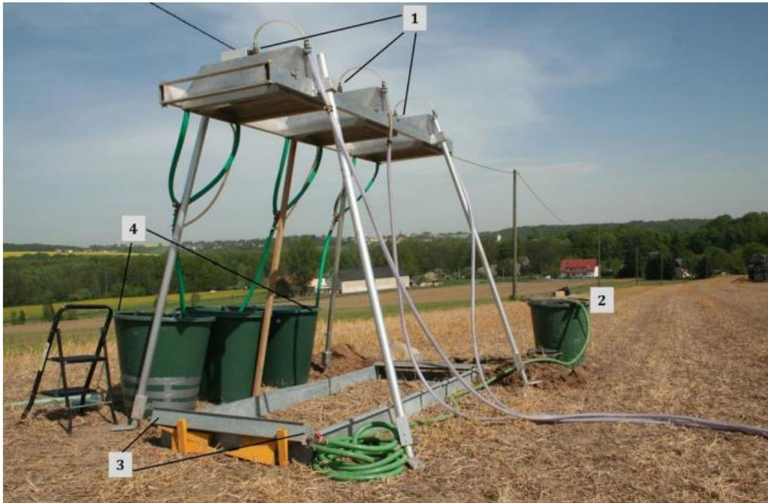
Figura 2.2: Simulador de chuva portátil configurado com (1) três bicos oscilantes, (2) um barril para coletar o escoamento carregado de sedimentos para a segunda fase do experimento, (3) o modulo de refluxo para introduzir o escoamento adicional de (2) para estender o comprimento da inclinação e (4) três barris para coletar o excesso de água da chuva dos bicos oscilantes para circulação (Kaiser *et al.*, 2018).
