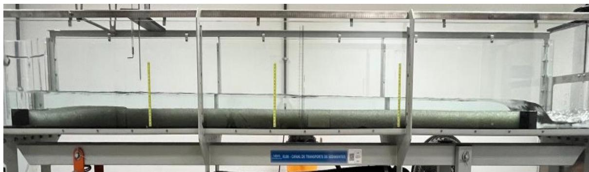
Figura 6.1: Ensaio de erosão por arraste.
