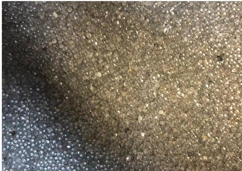
Figura 5.4: Material granular utilizado – Esferas de vidro.
