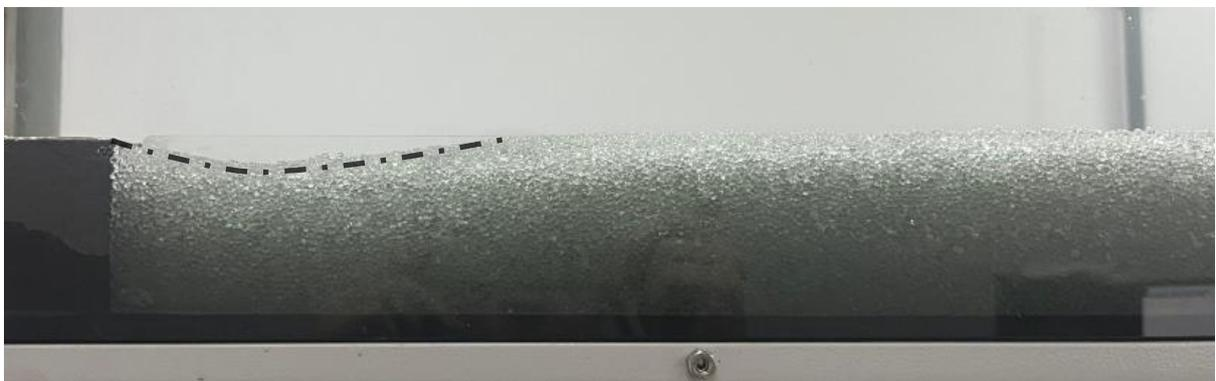
Figura 6.4: Perfil do leito após ensaio na terceira condição ( $Q = 15 \text{ m}^3/\text{h}$  e  $i = 0 \%$ ).
