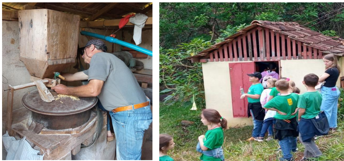
Figura 9. Foto 1. Interior do moinho, ajustando as correias e regulando a queda do milho.
