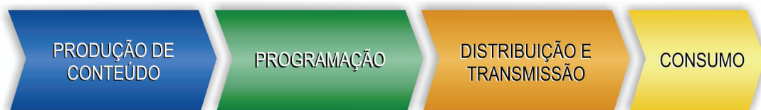
Figura 3 – Estrutura geral de um sistema de televisão aberta analógica.
