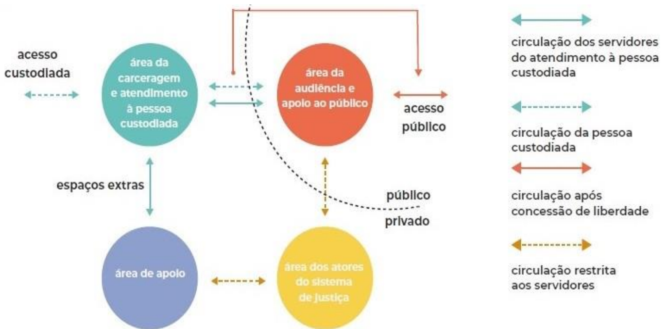
Figura 2 – Arquitetura Judiciária para Audiências de Custódia: setorização funcional e público x privado
