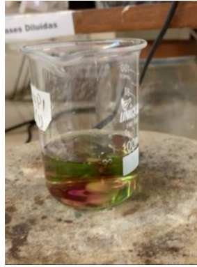
Titulação em análise de Proteína Bruta (Kjeldahl)
