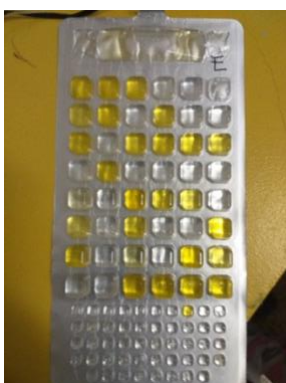
Cartela Collilert® (coliformes totais e termotolerantes)
