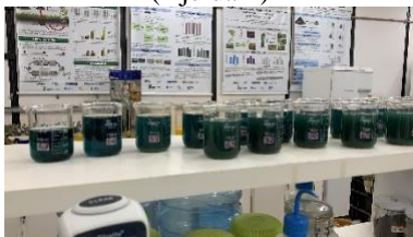
Amostras após análise de Carbono Total (Walkley-Black)
