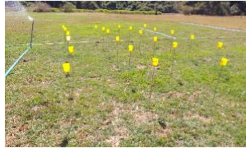
Ensaio de uniformidade do sistema de irrigação
