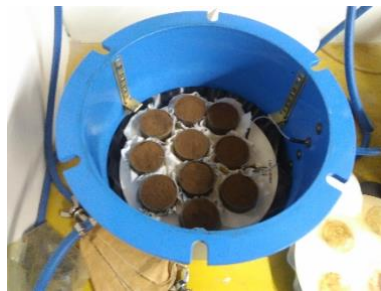
Amostras indeformadas de solo em Extrator de Richards
