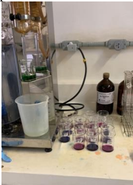
Análise de nitrogênio total (Kjeldahl)
