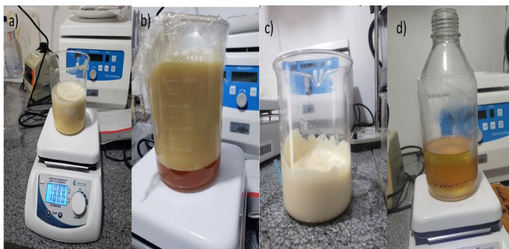
Figura 6 - Etapas da polimerização do óleo vegetal da C. Guianensis a) Diluição o óleo de C. Guianensis em solução de KOH. b) Processo de separação do Ácidos Graxos e do Glicerol. c) e d) Os Ácidos Graxos, antes e depois da polimerização.
