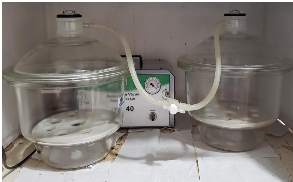
Figura 10 - Aparato experimental utilizando dois dessecadores para separar o Estrato Córneo das outras camadas da pele (derme e epiderme) (Fonte: Próprio Autor).
