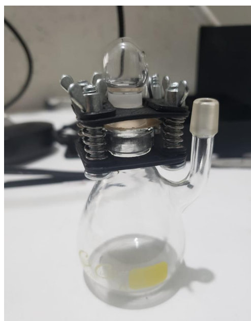
Figura 9 - a) Célula para estudos de permissão passiva construída neste trabalho b) Componente do aparato que foi modelado e impresso em 3d ( Fonte: Próprio Autor ).
