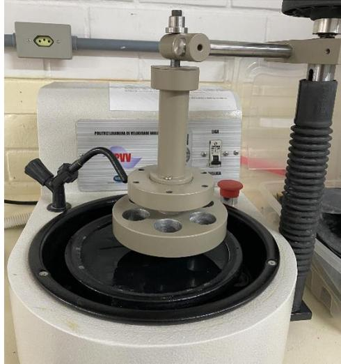
Figura 3. Máquina politriz circular para polimento e padronização das amostras.
