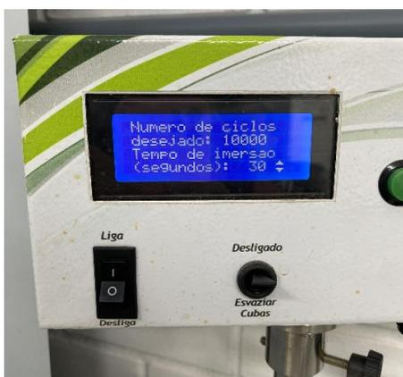
Figura 13. Termocicladora configurada para banho do grupo de amostras no T1 (termociclagem), durante 30 segundos para 10.000 ciclos
