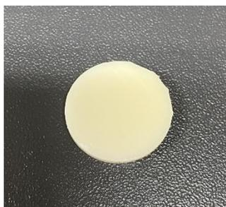
Figura 1. Disco cilíndrico impresso nas dimensões de 18x3mm.
