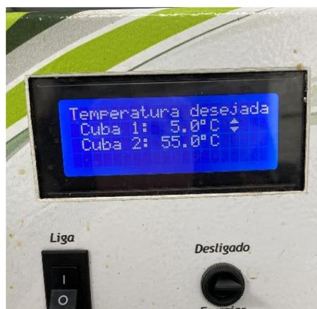
Figura 14. Temperatura da água alternada em 5°C e 55°C.
