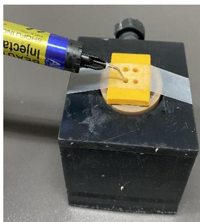
Figura 6. Posicionamento da resina *flow* Beautifil Injectable XSL (Shofu, Japão) na base de resina para impressão de coroas provisórias em 3D.
