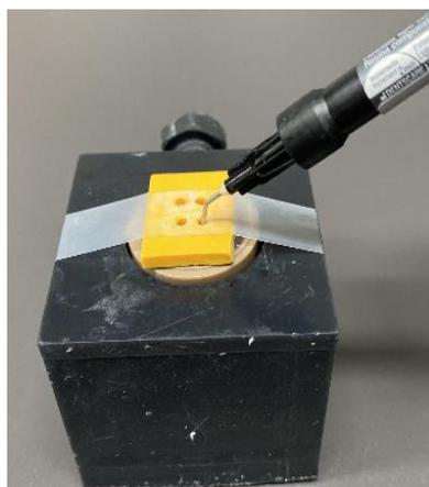
Figura 7. Posicionamento da resina *flow* Opallis (FGM, Brasil) na base de resina para impressão de coroas provisórias em 3D.
