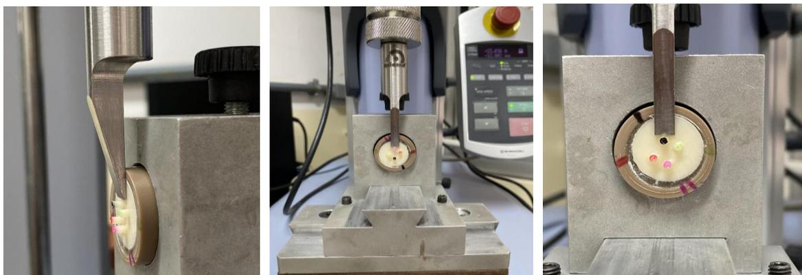
Figura 15A: Ponta edentada em formato de cunha posicionada na amostra
