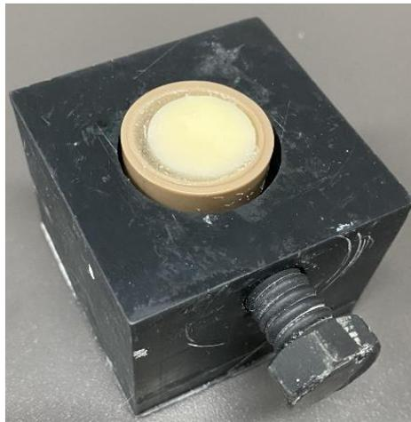
Figura 4. Amostra posicionada em base impressa em resina *splint* para impressão 3D.
