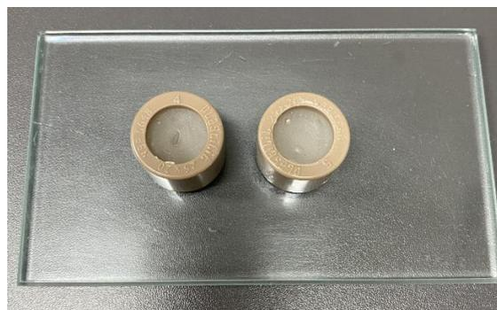
Figura 2. Cilindros incluídos em buchas de redução de PVC com resina acrílica autopolimerizável incolor.
