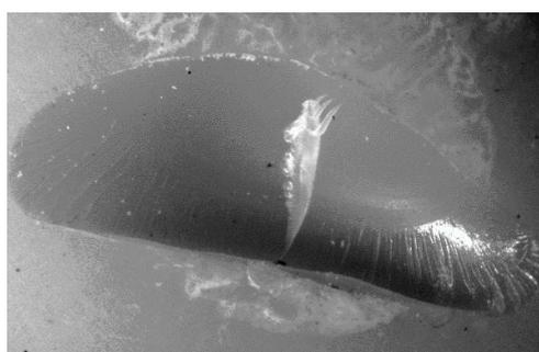
Figura 18. Fratura do tipo Coesiva em espécime do grupo GA em T1. Magnificação de 2x.
