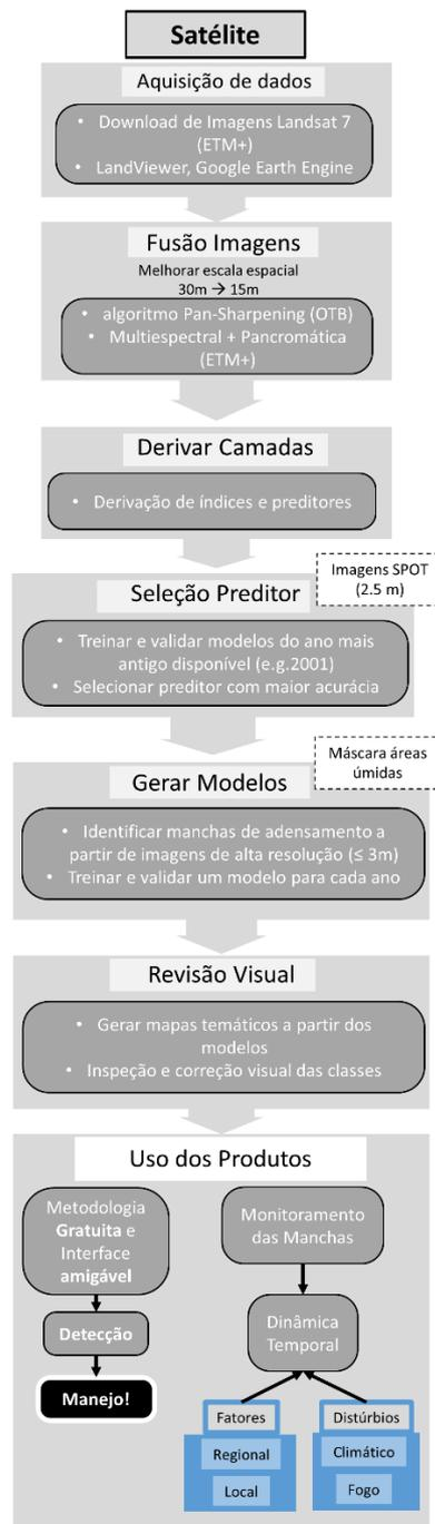
**Figura 3.** Fluxograma ilustrando o processamento de imagem via satélite, classificação e avaliação de precisão e uso dos produtos.
