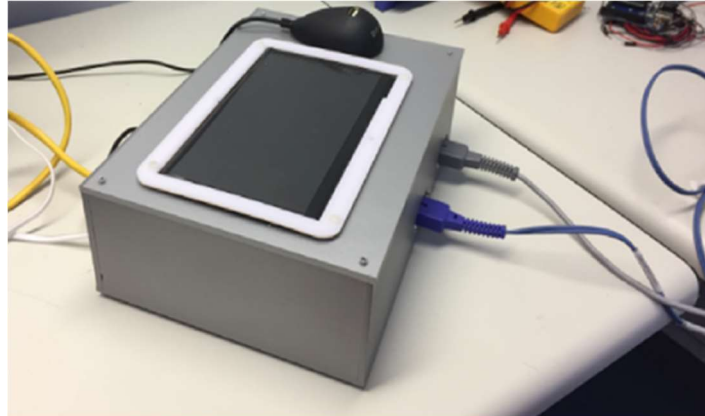
Figura 9 - Versão 1 do protótipo de oximetria de pulso desenvolvida no Departamento de Engenharia Elétrica da Faculdade de Tecnologia da Universidade de Brasília (ENE-FT-UnB).
