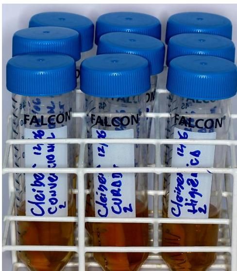
Figura 7 – Amostras com e sem contenção incubadas nos tubos Falcon contendo *S. mutans* a 37 °C, 48 horas.
