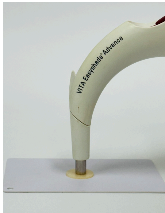
Figura 6: Espectrofotômetro Easyshade® (VITA) posicionado sobre corpo de prova.
