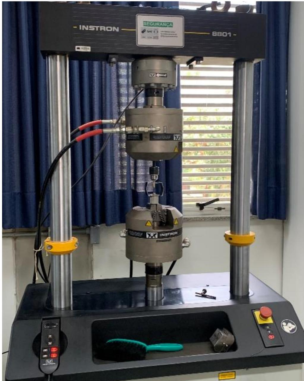
Figura 4 – Máquina de teste universal Instron® 8801.
