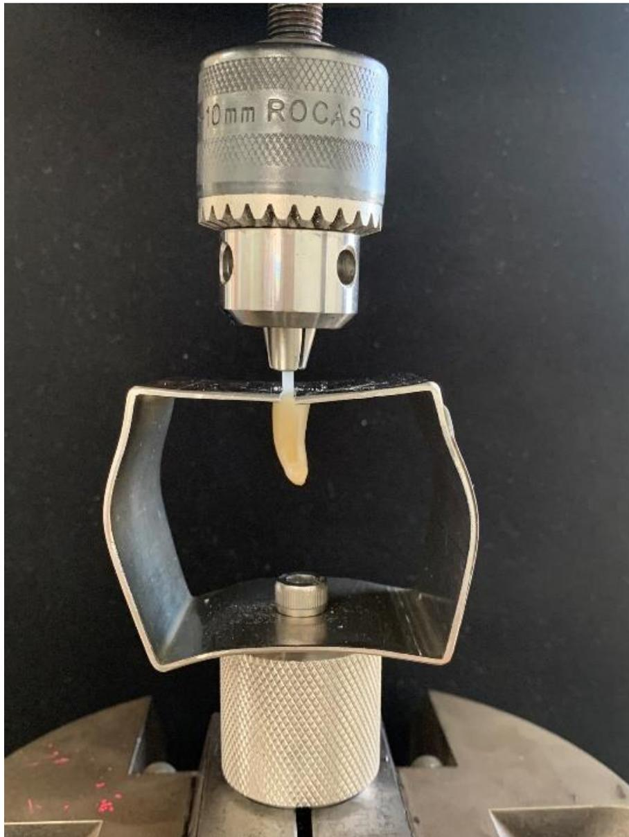
Figura 5 – Aparato de fixação do espécime para realização do teste pull out.
