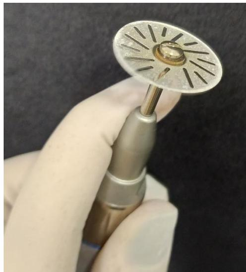
Figura 1 – Disco diamantado flexível dupla face em peça de mão
