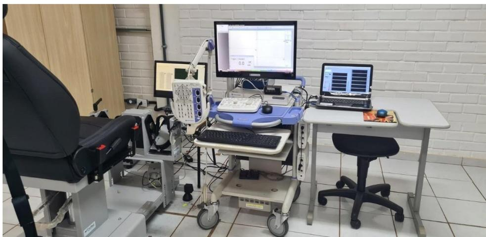
**Figura 4.2:** A esquerda: cadeira com suporte instrumentado (Cefise, Brasil) e a frente, o monitor para *feedback* visual do voluntário. Ao centro: equipamento Nihon-Kohden. Há direita laptop contendo o programa LabView (*National Instruments*, EUA).
