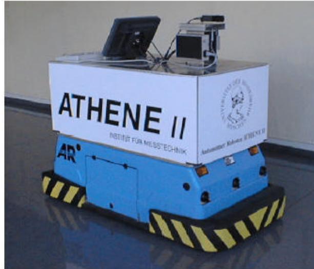
Figura 2.7 - Robô móvel inteligente Athene II , usado principalmente para estudos de navegação em ambiente interno e aprendizagem de máquina (Bischoff e Graefe, 1998).
