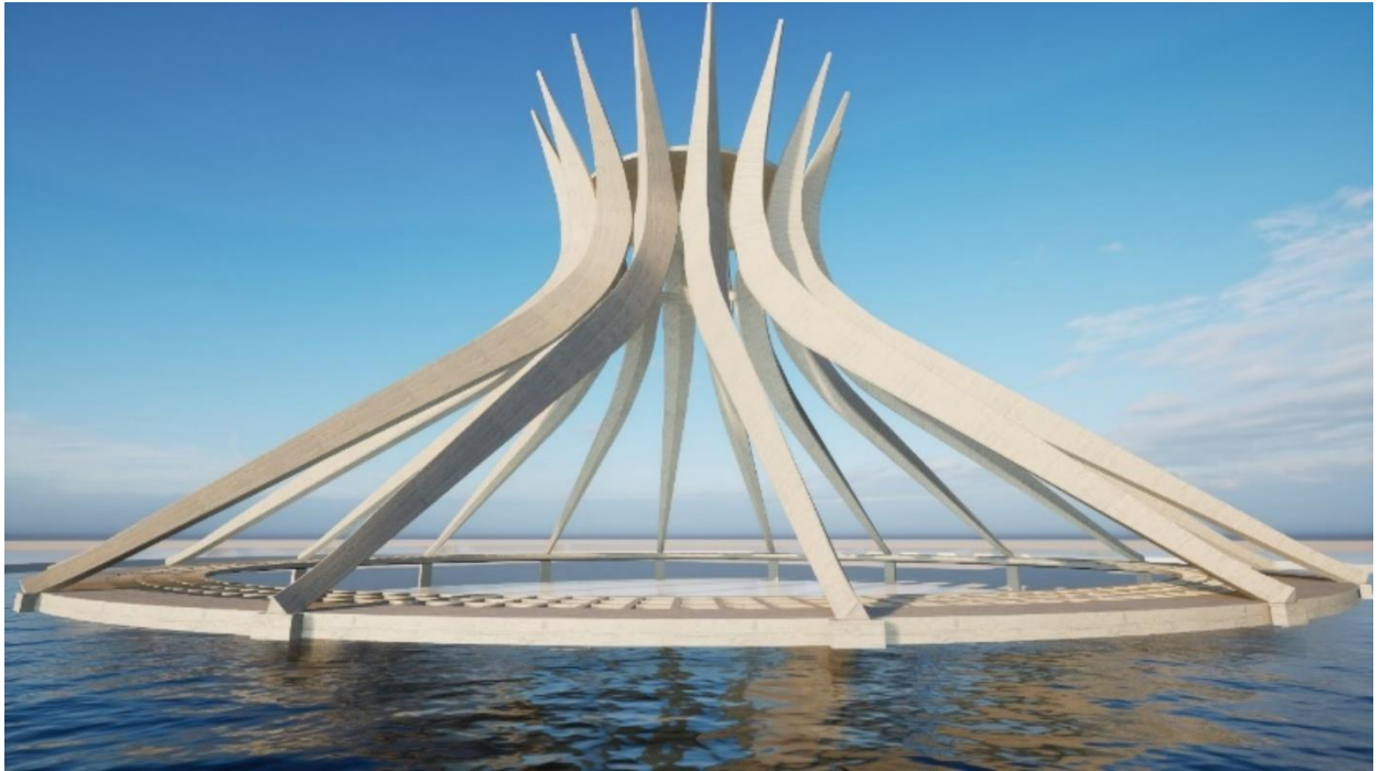
Figura 164. Modelagem tridimensional do sistema estrutural da Catedral Metropolitana de Brasília. Fonte: Autorial.
