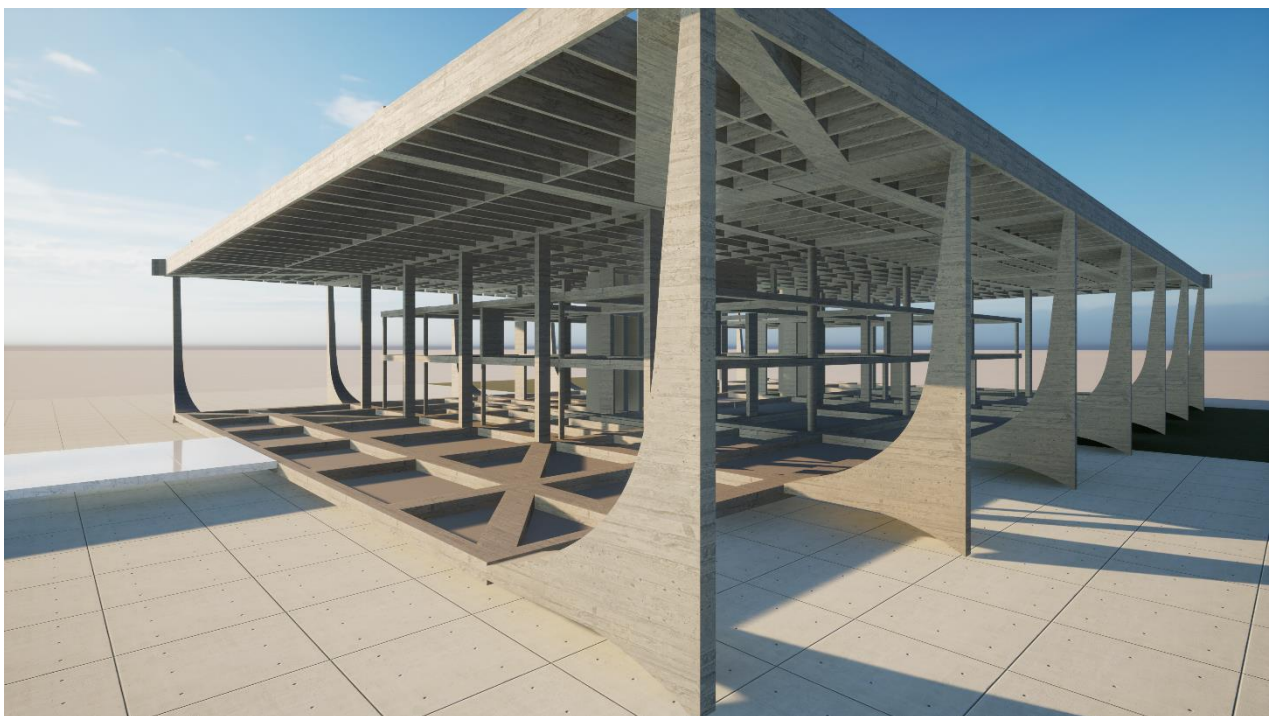
Figura 130. Detalhe da primeira laje do Palácio do Supremo Tribunal Federal. Fonte: Autoral.
