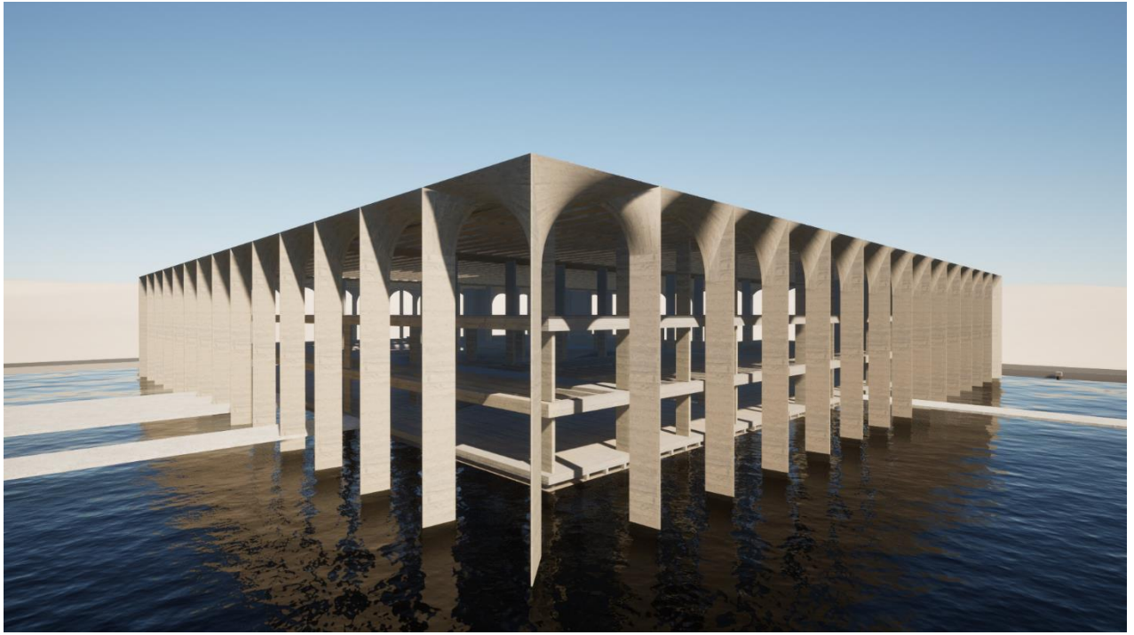
Figura 70. Modelagem tridimensional do sistema estrutural do Palácio do Itamaraty. Fonte: Autoral.
