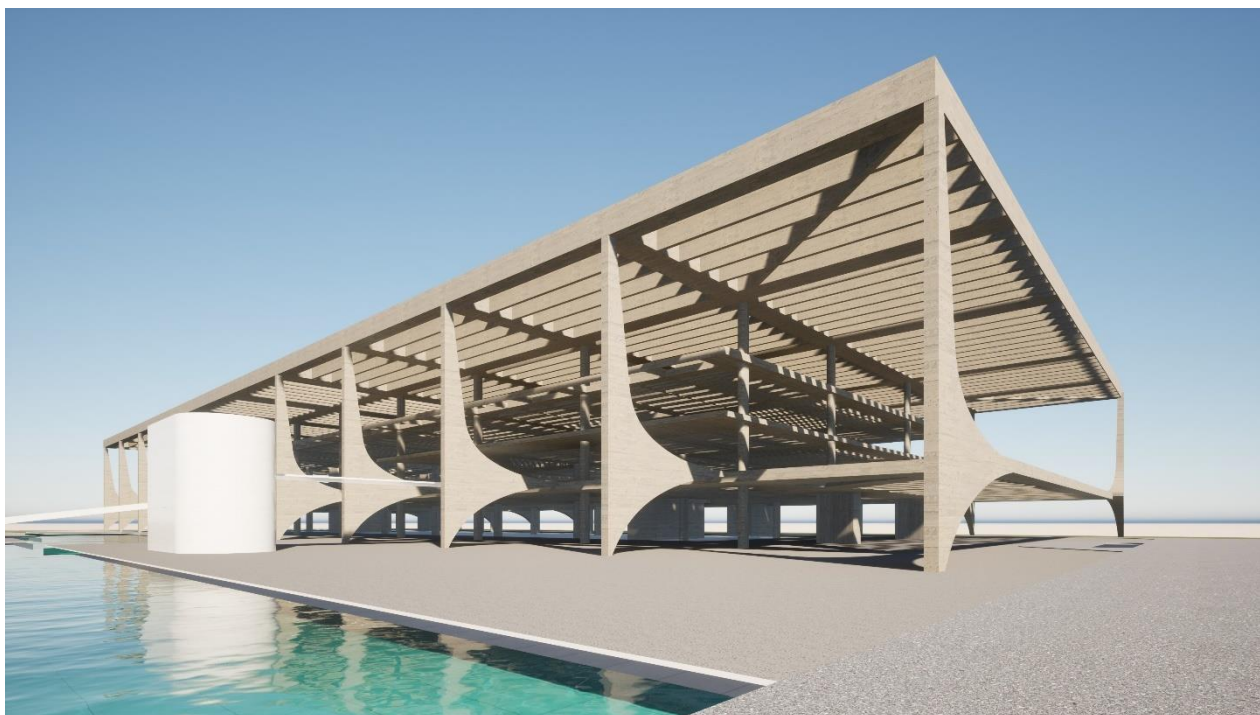
Figura 146. Modelagem tridimensional do sistema estrutural do Palácio do Planalto. Fonte: Autoral.
