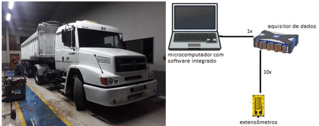
Figuras 115 – Desenho esquemático ensaios
