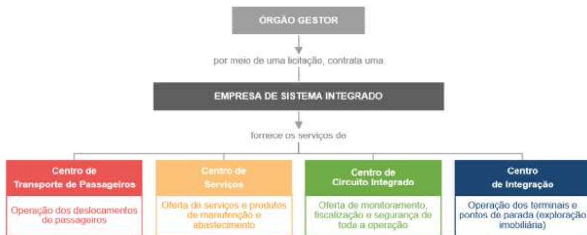
Figura 4.6: Estrutura do Arranjo
