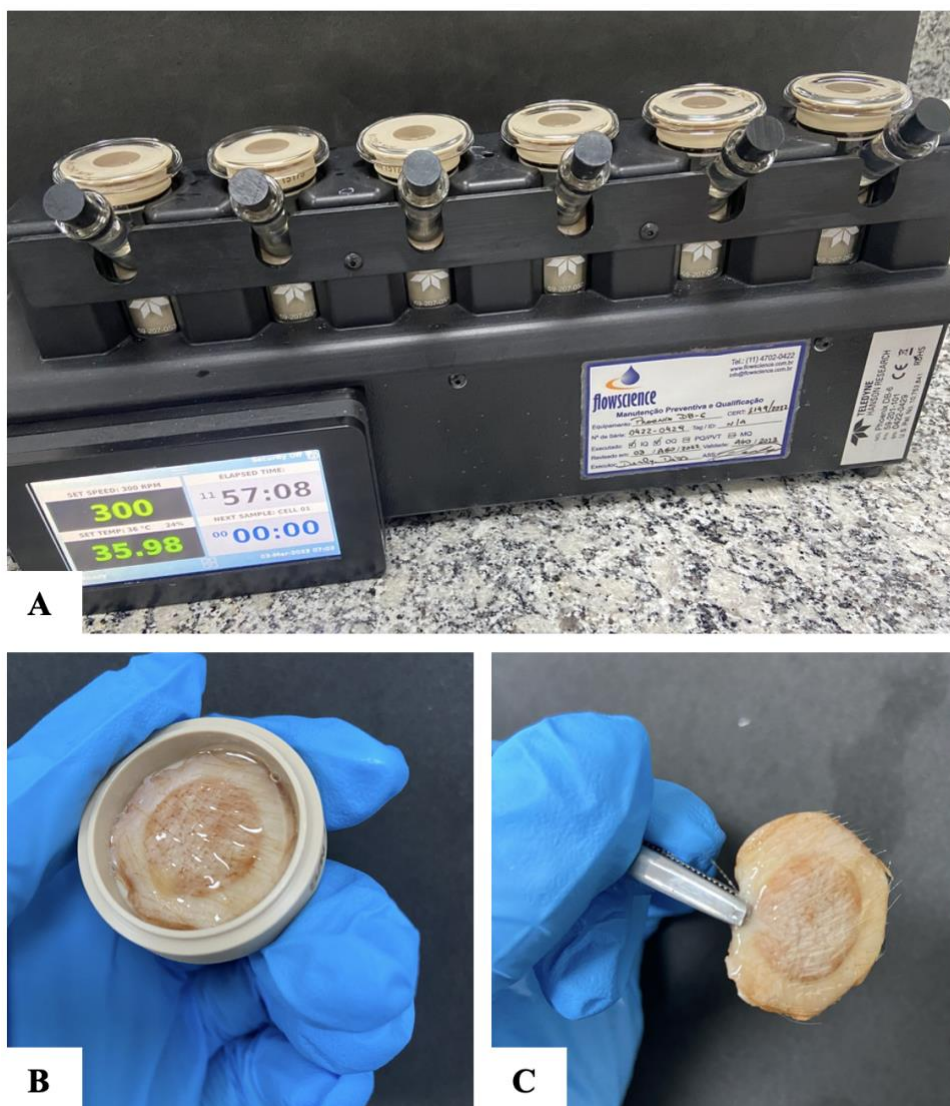
Figura 13. Representação do equipamento Hanson utilizado nas permeações cutâneas. A – Equipamento e suas células em atividade; B – Célula de difusão com a pele inserida após o tempo de ensaio; C – pele após o ensaio com as formulações.
