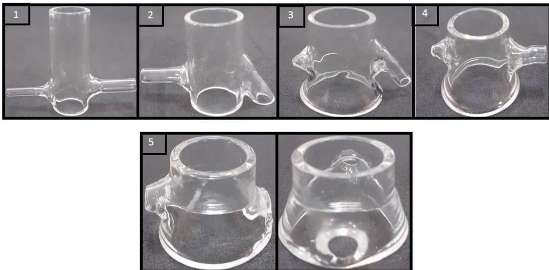
**Figura 18.** Imagens das versões dos compartimentos doadores fabricadas em vidro. Imagem adaptada de Barbalho et al., (2023).
