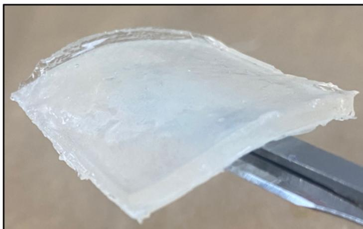
**Figura 53.** Imagem da membrana híbrida baseada em hidrogel de três camadas.
