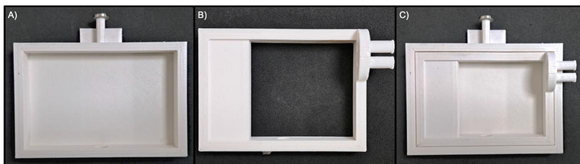
**Figura 41.** Imagens do dispositivo OphthalMimic impresso em 3D com material ABS, e devidas modificações para 2 versão. A) base do dispositivo que acopla a membrana polimérica. B) Parte superior com simulação da bolsa de *cul-de sac*, entrada de fluxo lacrimal (lateral superior direita) e saída de fluxo lacrimal simulado na região central do dispositivo. C) Dispositivo com montagem completa.
