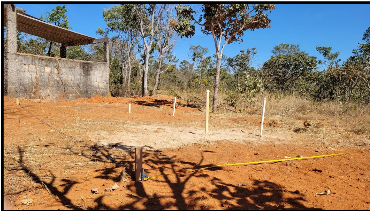
Figura 6 - Fotografia da área das SEP01 e SEP02 com o arranjo das trenas, corda e cabo de aço devidamente finalizado para aquisição dos dados GPR quasi -3D.
