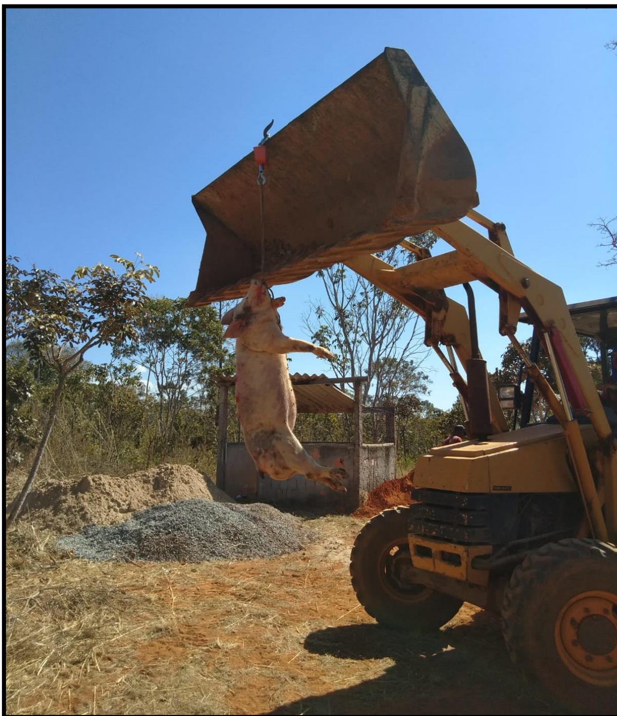
Figura 4 - Fotografia do momento de pesagem do alvo sepultado na SEP02. Para medição do peso dos alvos foi pendurada na pá da retroescavadeira uma balança digital de gancho. Ao fundo na fotografia é possível observar a areia e a brita utilizadas para preenchimento dos horizontes das SEP's.
