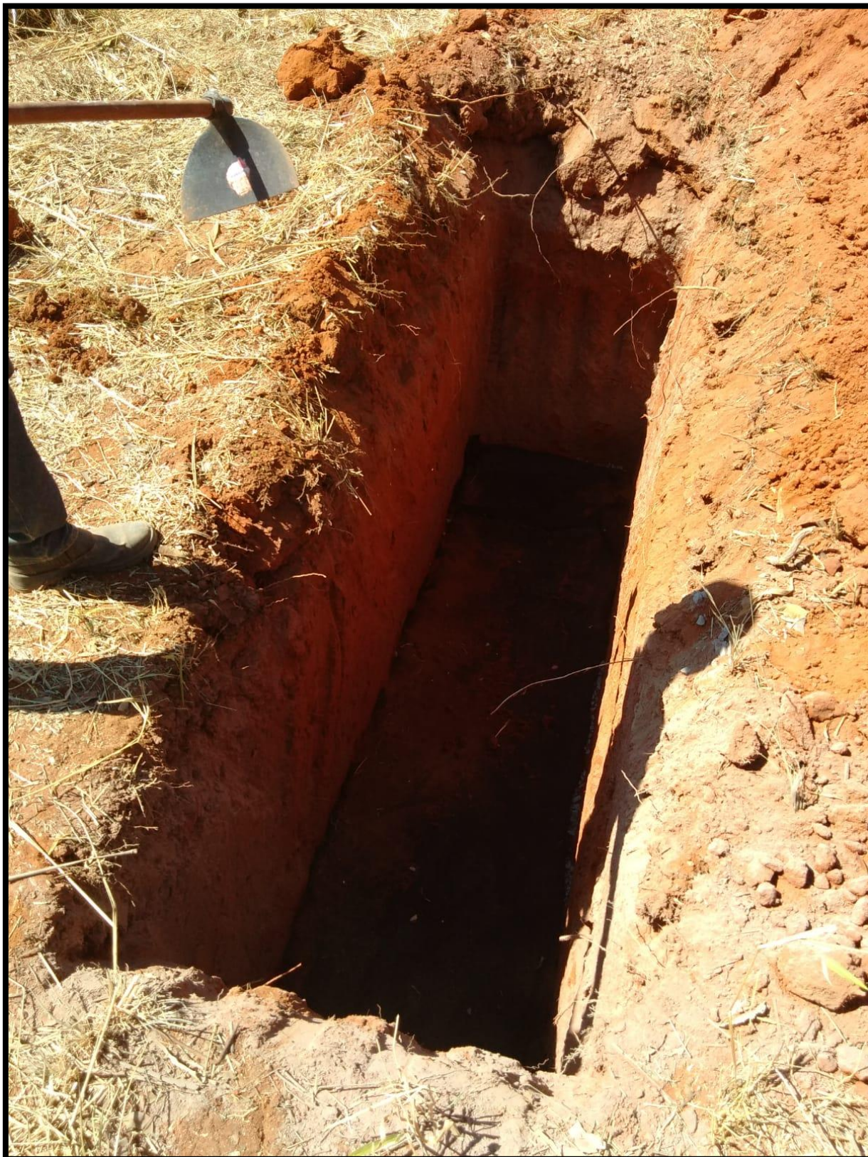
Figura 3 - Fotografia da sepultura experimental após colocação do bidim.
