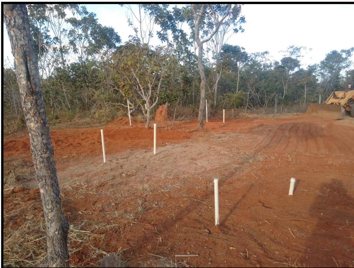
Figura 1 - Fotografia tirada após a expansão do FOREN/FAL onde é possível visualizar os canos utilizados para o monitoramento de CH 4 e CO 2 .
