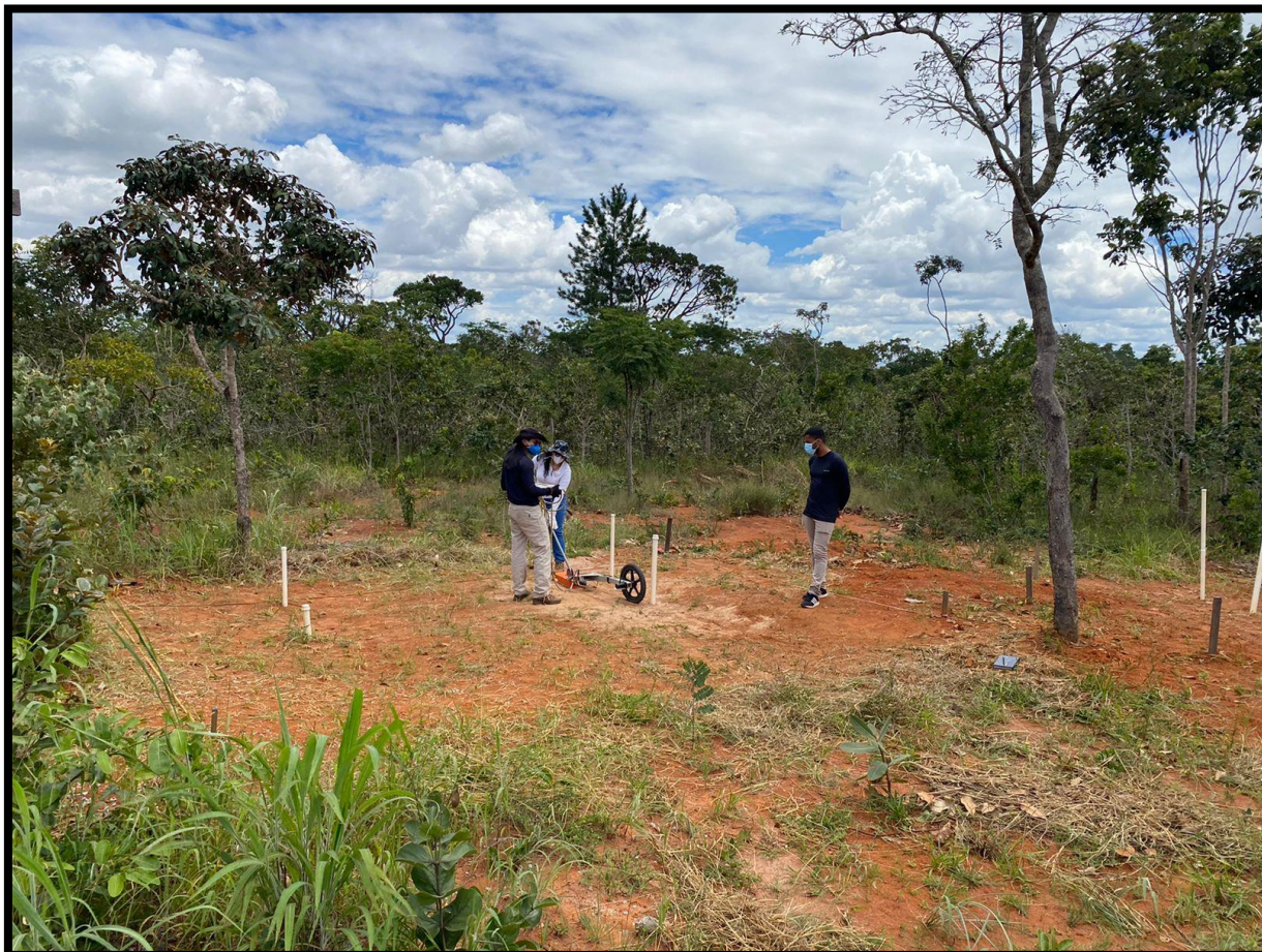
Figura 8 - Fotografia da aquisição dos dados GPR na área do sítio controlado com a antena de 900MHz, no período chuvoso.
