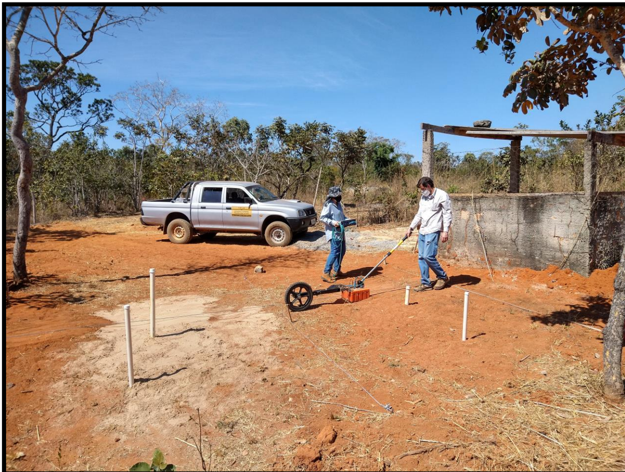
Figura 7 - Fotografia da primeira aquisição dos dados GPR na área do sítio controlado com a antena de 400MHz, no período de seca, logo após a expansão do FOREN/FAL.
