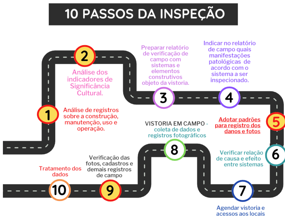
Figura 104 - Dez passos para inspeção.
